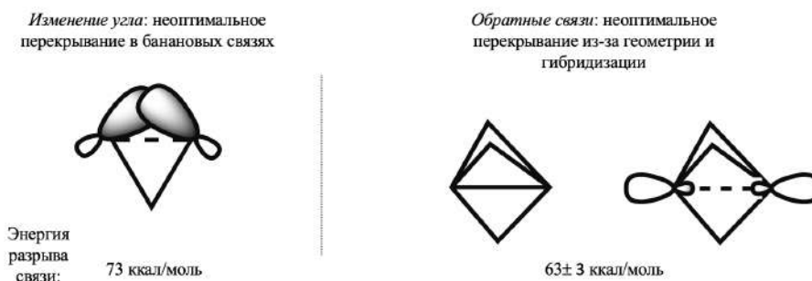
Рисунок 10 – Геометрические ограничения, приводящие к уменьшению перекрывания и ослаблению связей в напряженных системах.
