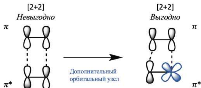
Рисунок 3 – Влияние симметрии орбиталей на [2+2]-циклоприсоединение.
