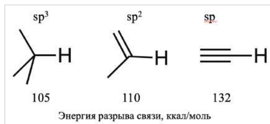
Рисунок 6 – Гибридизация и прочность связей C-H.
