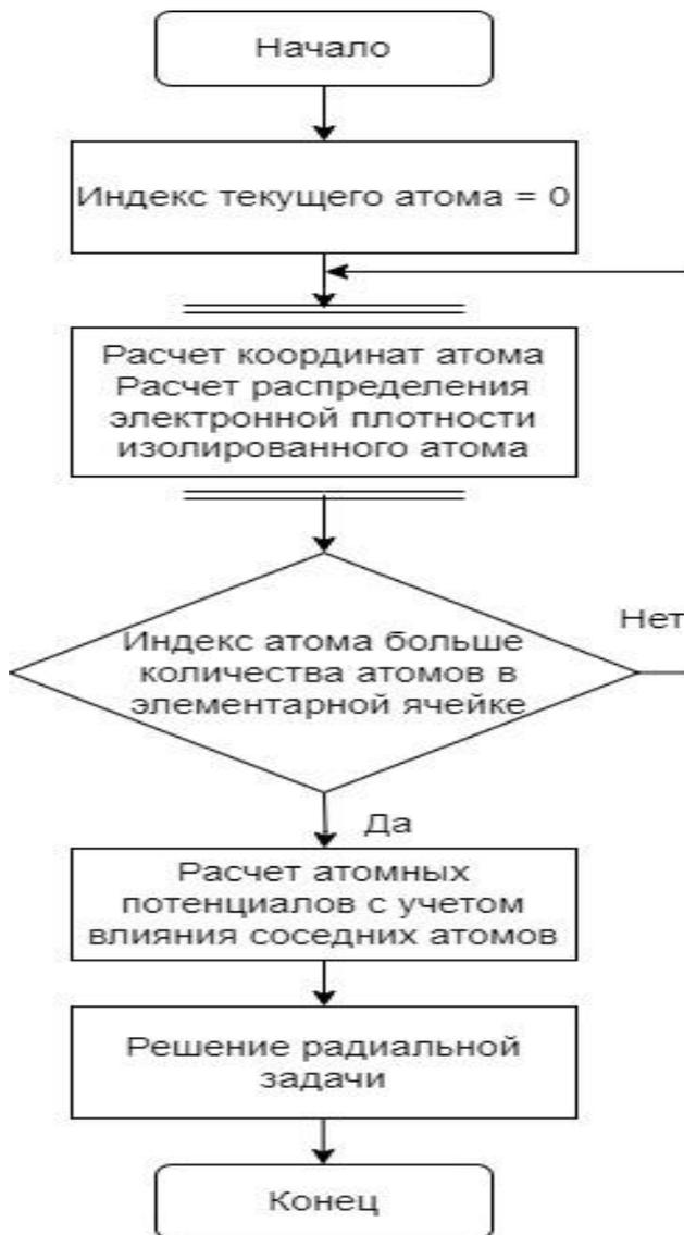
Рисунок 2 - Блок-схема решения атомной задачи
