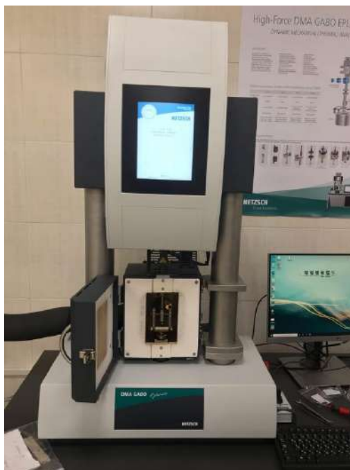
Рисунок 2.9 – Прибор DMA GABO EPLEXOR 25N
