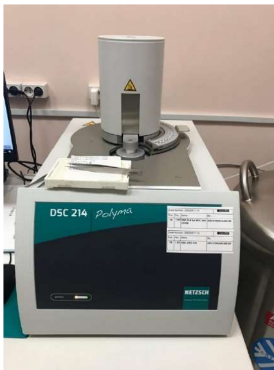
Рисунок 2.10 – Дифференциальный сканирующий калориметр DSC 214 Polyma
