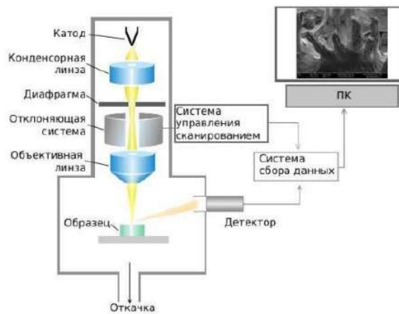
Рисунок 2.8 – Принципиальная схема СЭМ
