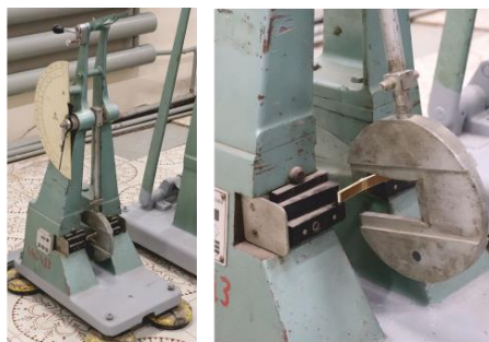
Рисунок 12 – Маятниковый копер для испытания на ударную вязкость
