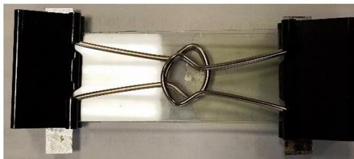
Рисунок 30 – Фотография импровизированной ячейки с толщиной слоя 214 мкм
