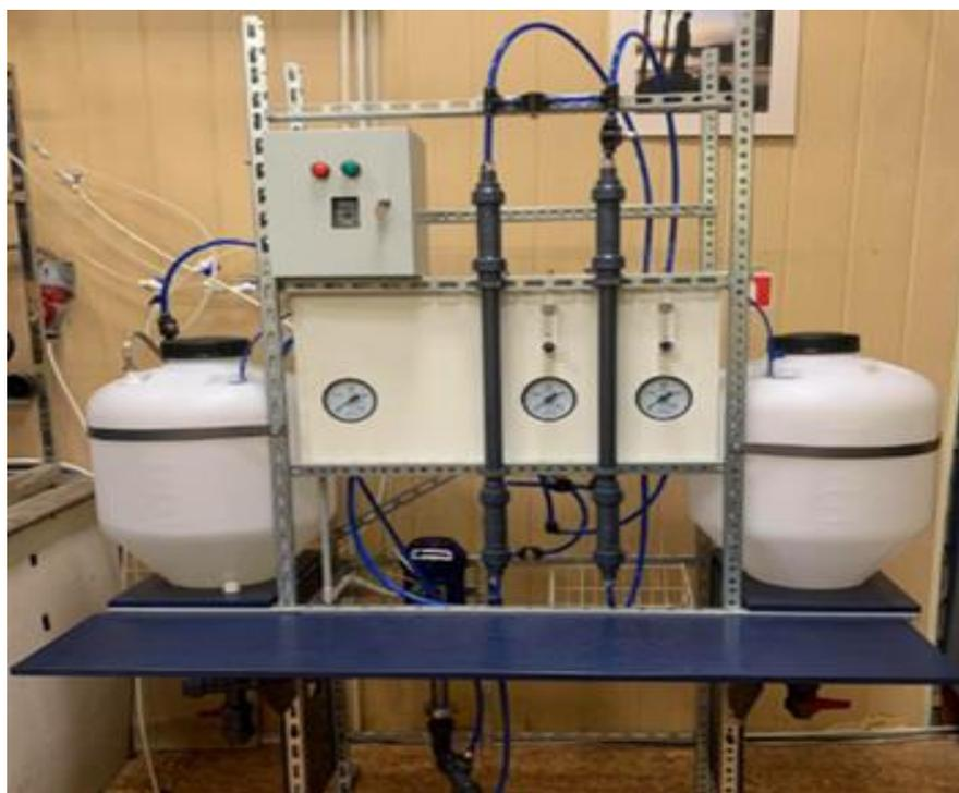
Рисунок 2.11 – Внешний вид фильтрационной мембранной установки.
