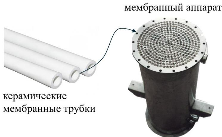
Рисунок – 3.32 Мембранный аппарат на базе керамических трубчатых элементов
