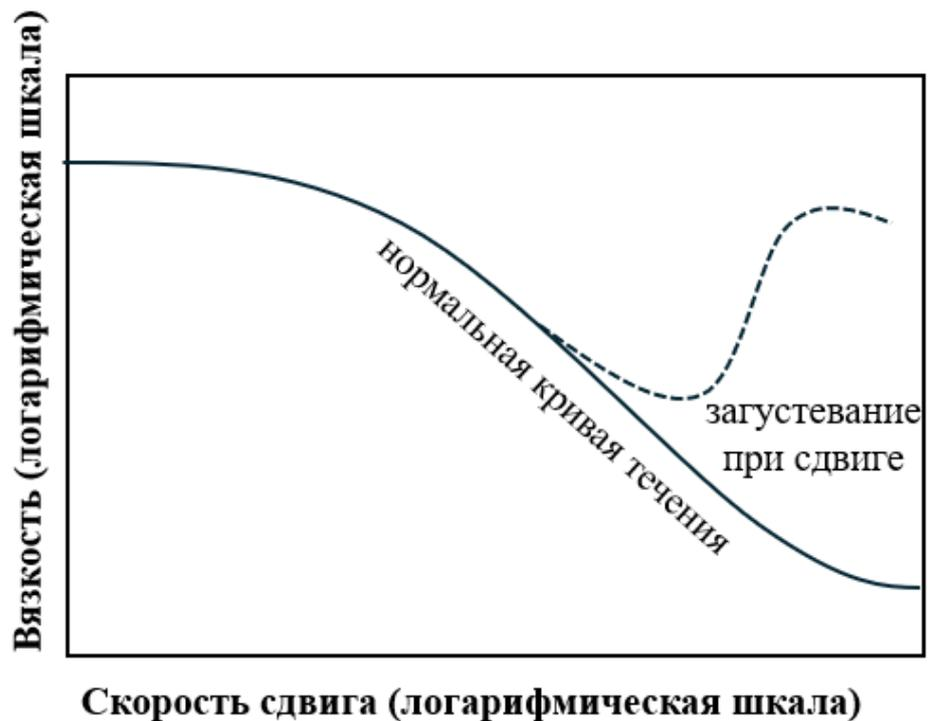
Рисунок 2.24 – Нормальная форма кривой течения неньютоновских жидкостей, измеренная в достаточно широком диапазоне скоростей сдвига. Также показано типичное поведение запускования при сдвиге
