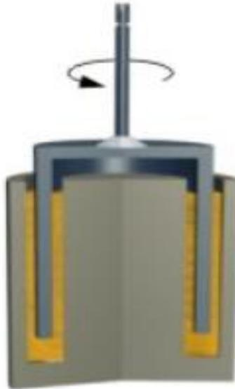
Рисунок 2.25 – Конструкция вискозиметра с двойным зазором и концентрическими цилиндрами
