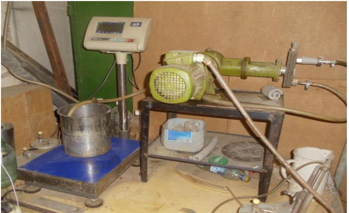
Рисунок 2.17 – Насос-дозатор с весами, на которых емкость с исходным продуктом
