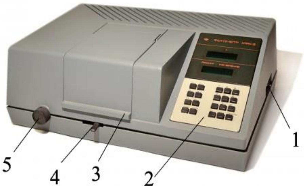
Рисунок 2.5 – Общий вид колориметра модели КФК-3МП
