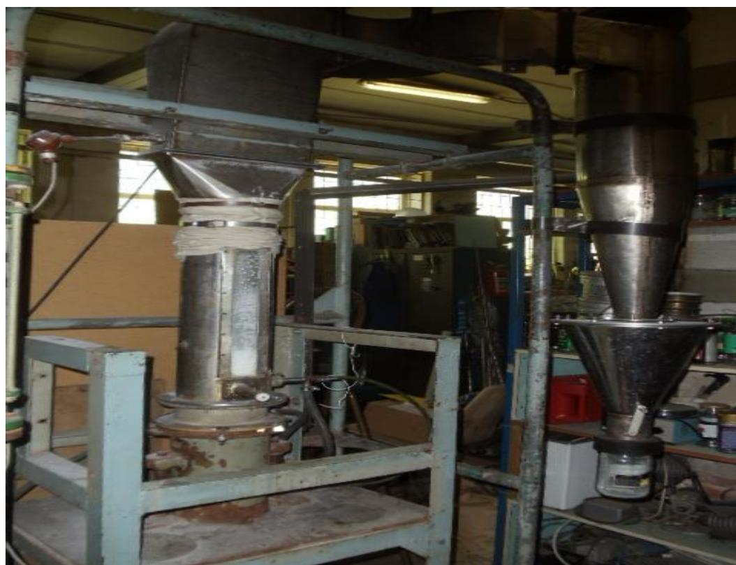
Рисунок 2.16 – Сушильная камера с гранулами инертного материала и циклоном
