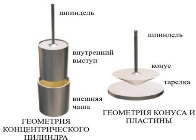
Рисунок 2.19 – Геометрии с равномерным распределением скорости сдвига по всей толще жидкости
