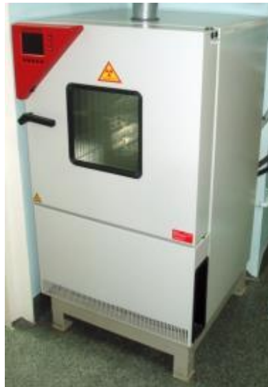
Рисунок 2.2 — Внешний вид климатической камеры МК 53
