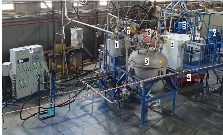
Рисунок 1.9 - Общий вид опытно-промышленной установки кондиционирования ОИОС методом включения в полимерное связующее (Россия, ФГУП «РАДОН») [11, 38]
