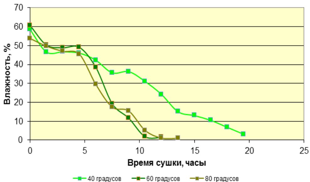
Рисунок 3.5 – Зависимость влажности от продолжительности сушки анионита с высотой слоя 30 см при различных температурах
