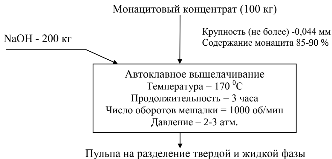
Рисунок 10 – Технологическая схема стадии автоклавного выщелачивания монацита
