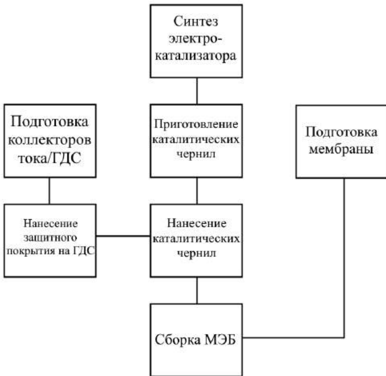
Рисунок 10 – Блок-схема технологических процессов для изготовления МЭБ
