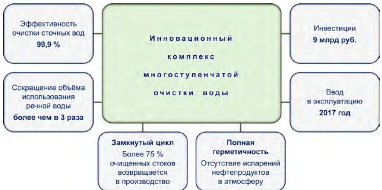
Рисунок 2.5.1 – Комплекс биологической очистки сточных вод «Биосфера» (составлен автором на основе [165])
