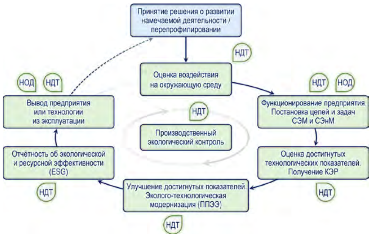
Рисунок 2.1.1 – Применимость концепции наилучших доступных технологий на всех этапах жизненного цикла промышленного предприятия (составлен автором)
