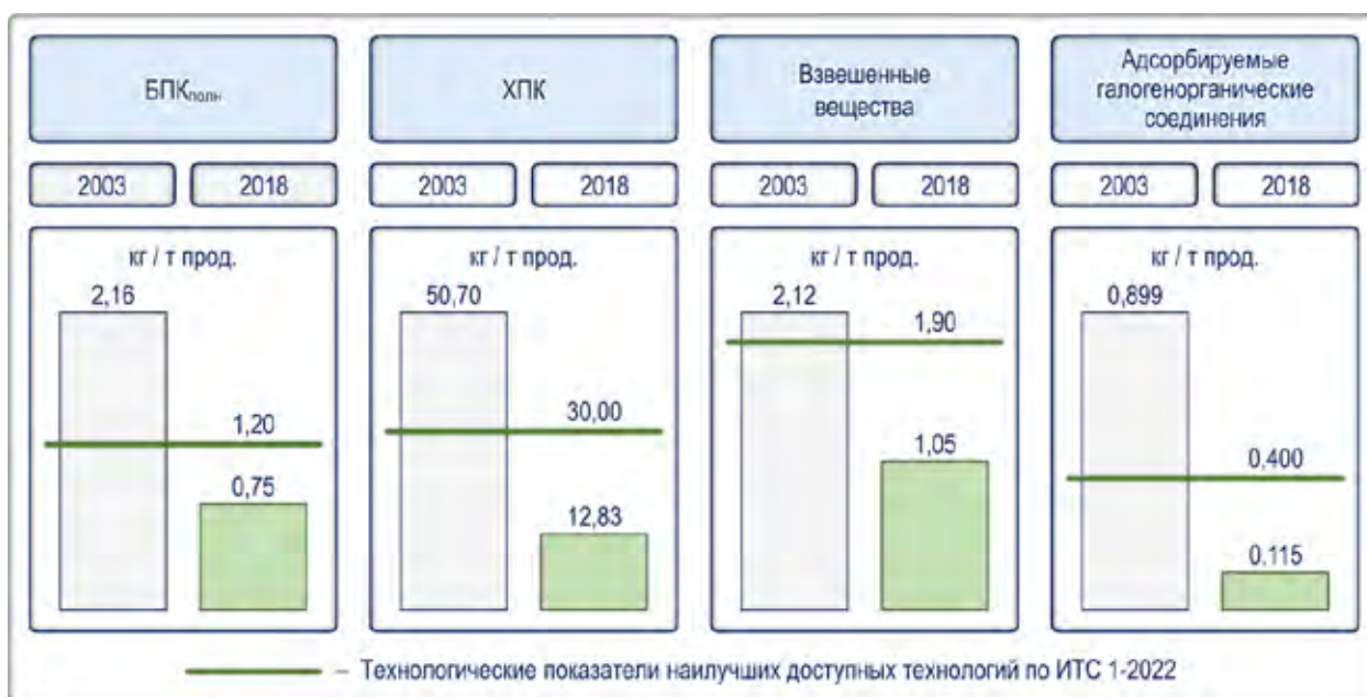
Рисунок 3.3.4 – Снижение содержания загрязняющих веществ в сбросах сточных вод производства белой целлюлозы на пилотном предприятии (составлен автором)
