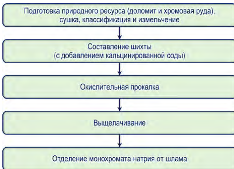
Рисунок 3.1.2 – Этапы производства монохромата натрия (составлен автором)
