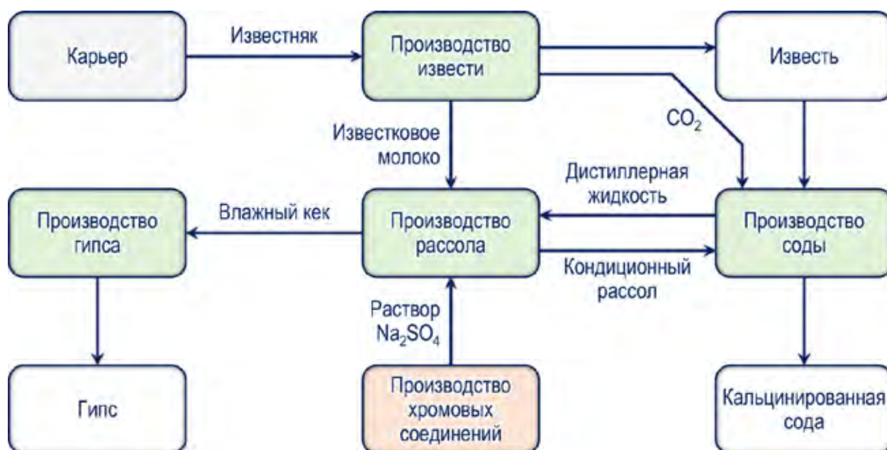
Рисунок 3.1.5 – Проектирование промышленного узла по производству гипса, извести и кальцинированной соды (составлен автором)
