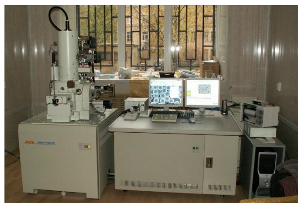
Рисунок 30 – (а) Фотография автоэмиссионного растрового электронно-ионного микроскопа Scios (FEI, США) и (б) растрового электронного микроскопа с полевой эмиссией JSM-7401F (JEOL, Япония)
