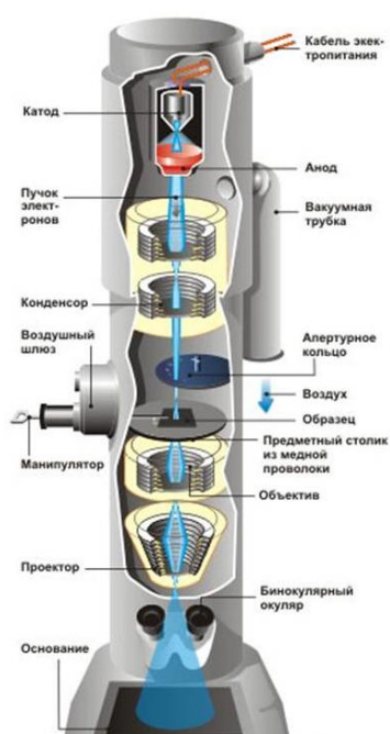
Рисунок 31 – Схема (слева) и фото (справа) просвечивающего электронного микроскопа Tescnai Osiris (FEI, США)
