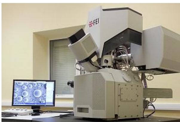
Рисунок 30 – (а) Фотография автоэмиссионного растрового электронно-ионного микроскопа Scios (FEI, США) и (б) растрового электронного микроскопа с полевой эмиссией JSM-7401F (JEOL, Япония)
