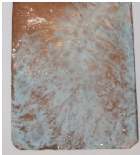
Рисунок 3.2.3 - Внешний вид анода после осаждения покрытий Cu-SiC
