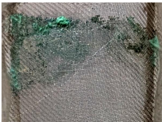
Рисунок 4.2 - Коррозионное разрушение бронзового сита в разделяемой смеси синтетическое масло/вода
