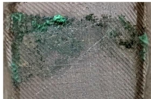
Рисунок 15 - Коррозионное разрушение бронзового сита без супергидрофобного покрытия в разделяемой смеси синтетическое моторное масло/вода
