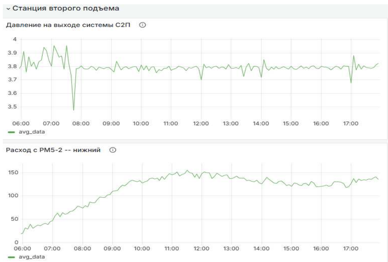
Рисунок 35 – Экранная форма панели оператора с отображением графиков параметров технологического объекта водозаборного узла (ВЗУ)
