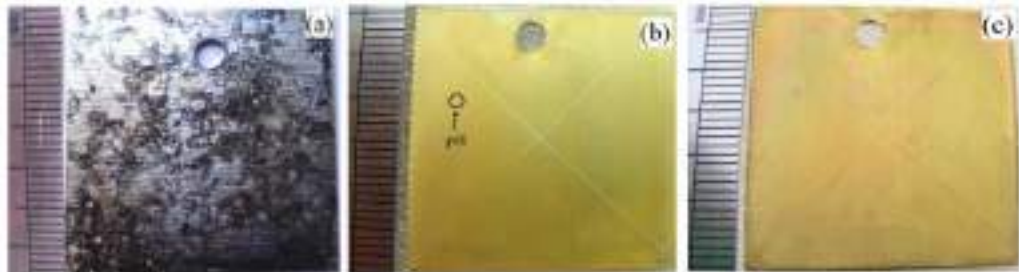
Рисунок 1.14 – Фотографии образцов с царапинами на магниевом сплаве AZ31 без пассивирующего покрытия (а) и с покрытием (b, c) после испытаний в 3,5% растворе NaCl в течение: а, b – 4 ч; c – 48 ч [142]
