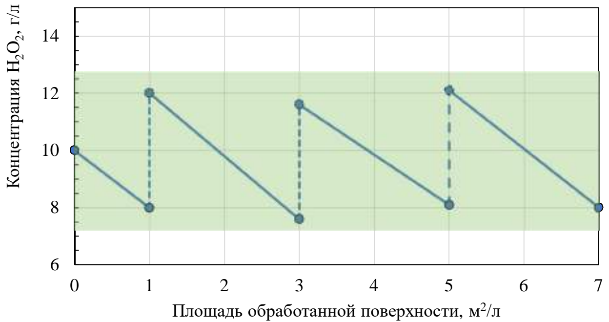
Рисунок 3.59 – Зависимость концентрации перекиси водорода в Si-содержащем пассивирующем растворе от площади обработанной поверхности при корректировке 37% раствором перекиси водорода
