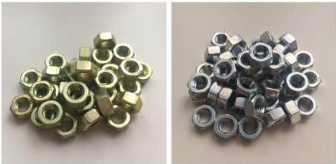
Рисунок 3.29 – Фотографии оцинкованных гаек после пассивации в растворах: а) церийсодержащем, б) – кремнийсодержащем
