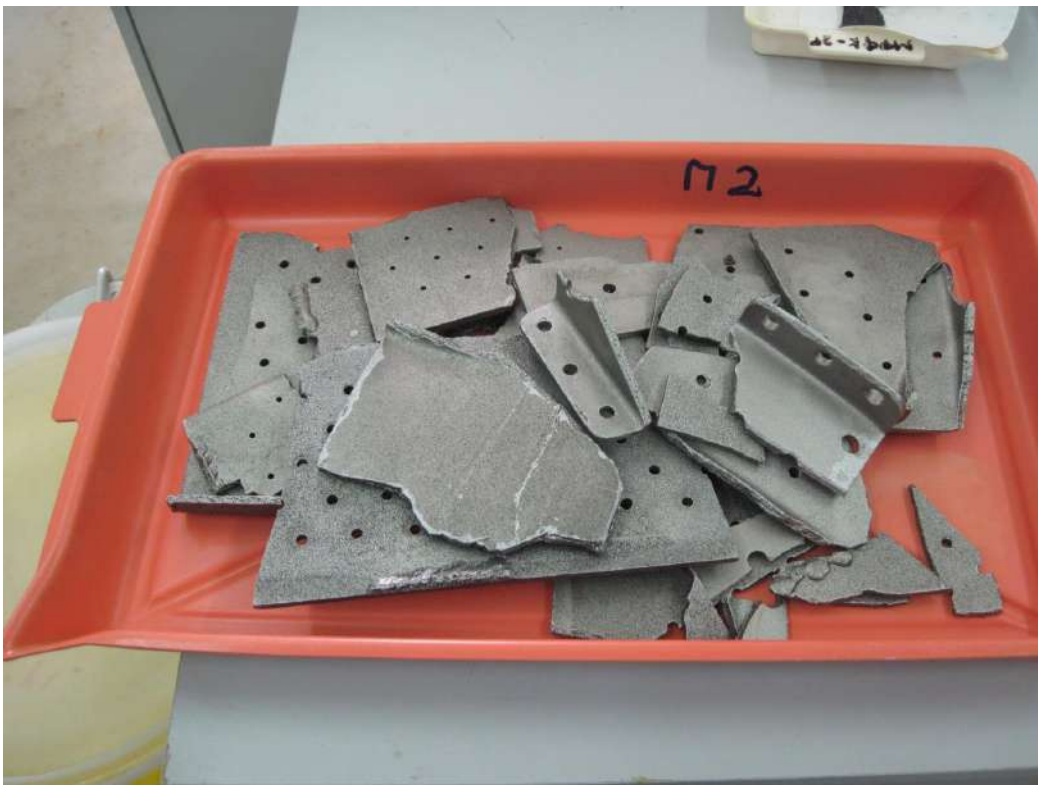
Рисунок 8.5 - Внешний вид образцов после абразивной дезактивации
