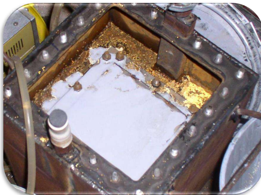
Рисунок 10.5 – Внешний контейнера с ИОС, пропитанной полимерным связующим
