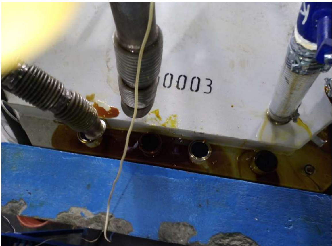
Рисунок 10.14 - Внешний вид контейнера НЗК со вставкой по окончании пропитки
