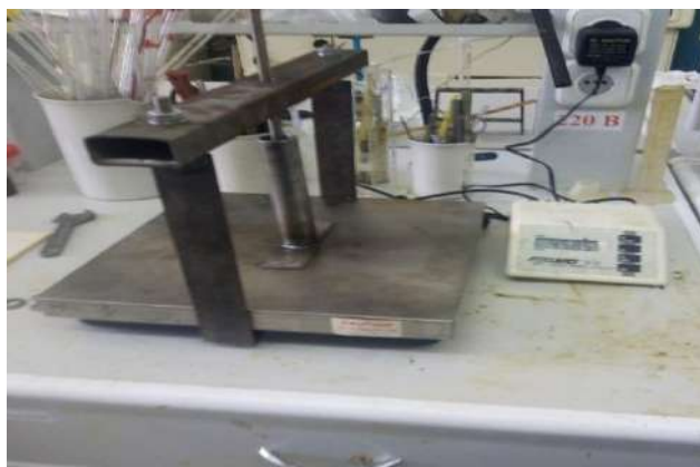
Рисунок 10.2 - Внешний вид установки для измерения давления набухания
