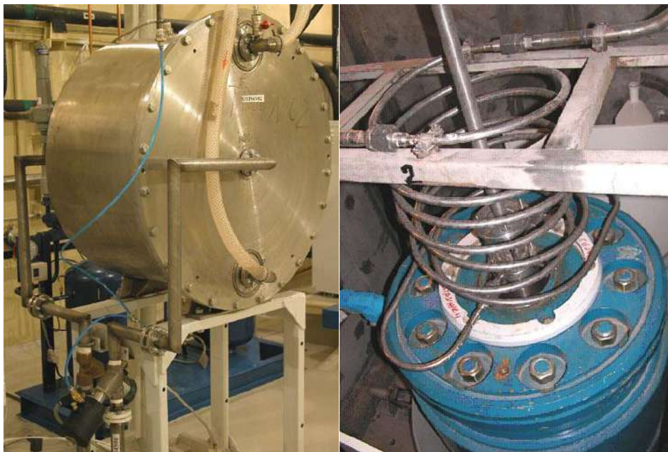
Рисунок 3.9 - Генератор озона и фильтр - контейнер
