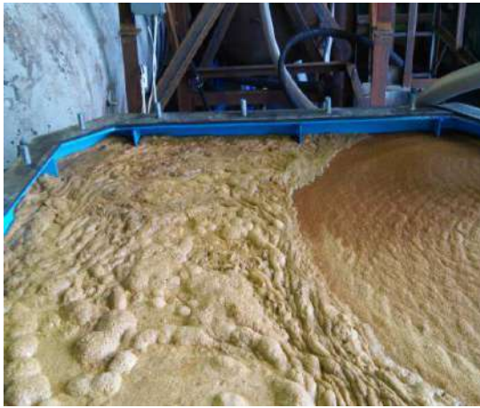
Рисунок 10.9 - Заполнение контейнера пульпой и обезвоживание ИОС
