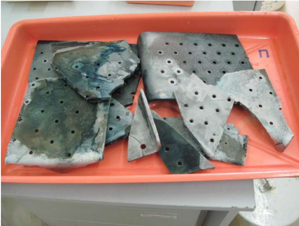
Рисунок 8.4 - Внешний вид образцов после жидкостной дезактивации
