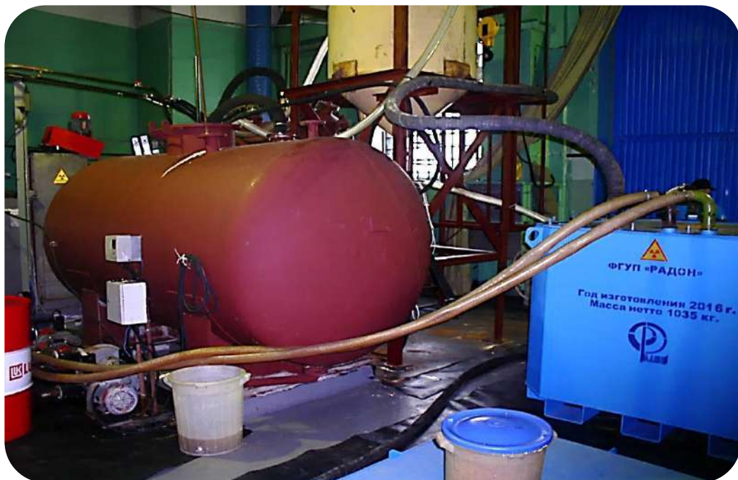
Рисунок 10.10 - Пропитка ИОС в контейнере КМЗ полимерным связующим
