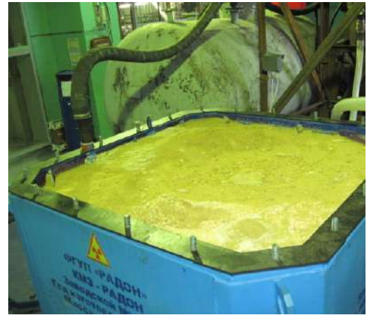
Рисунок 10.9 - Заполнение контейнера пульпой и обезвоживание ИОС
