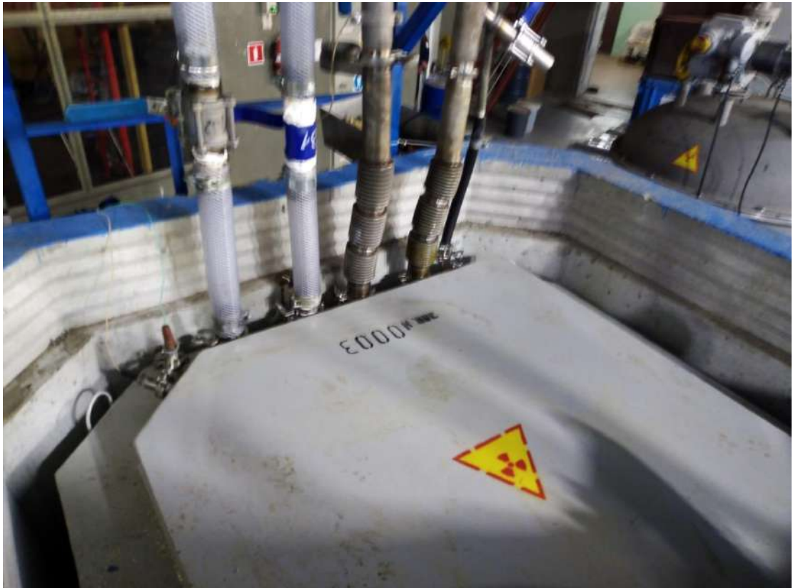
Рисунок 10.13 - Внешний вид контейнера НЗК со вставкой
