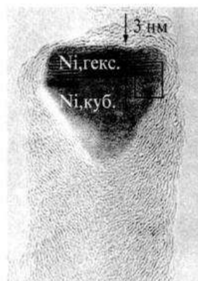
Рисунок 1.15 – Строение УНВ и частицы металлического никеля, 400°С, C_4H_6
