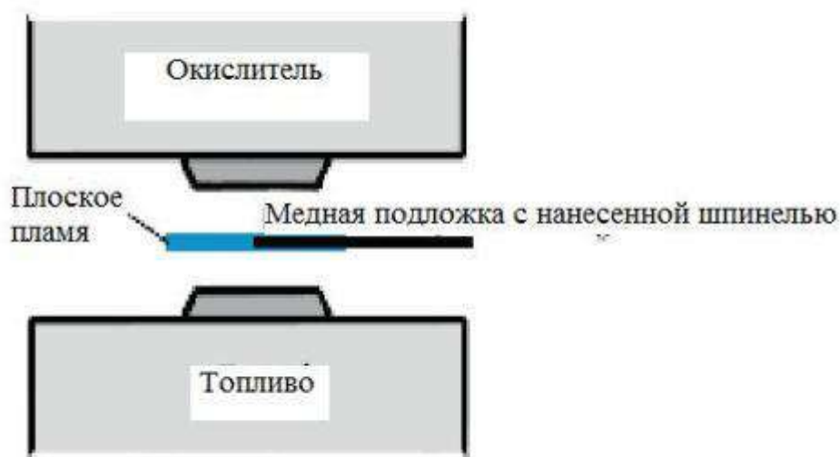
Рисунок 1.13 – Камера горения для осуществления синтеза в пламени
