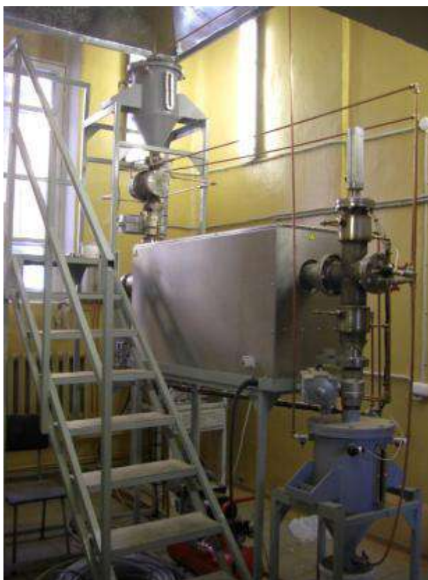
Рисунок 4.1 – Фото шнекового реактора синтеза УНТ непрерывного действия
