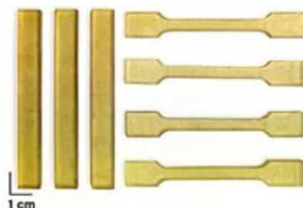
Рисунок 42 – Образцы, изготовленные для определения физико-механических свойств
