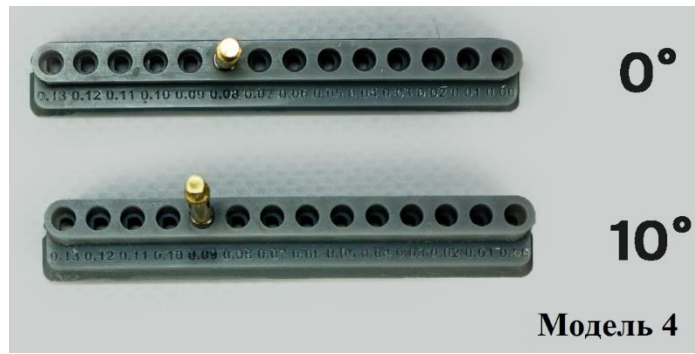
Рисунок 85 – Модель для оценки точности печати по втулкам при вертикальной ориентации и под углом 10^\circ
