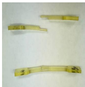
Рисунок 66 – Образцы с нанесенным Г-образным надрезом для дальнейшего восстановления
