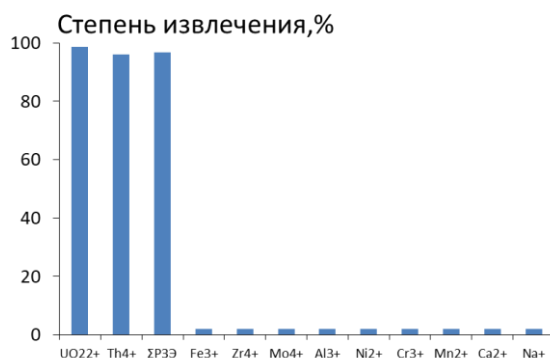
Рисунок 21 - Экстракция \text{U}(\text{VI}) , \text{Th}(\text{IV}) , \text{La}(\text{III}) , \text{Nd}(\text{III}) и \text{Eu}(\text{III}) 0,05 М раствором 10 в хлороформе из модельного азотнокислого раствора (2,5 М) в присутствии примесных элементов.
