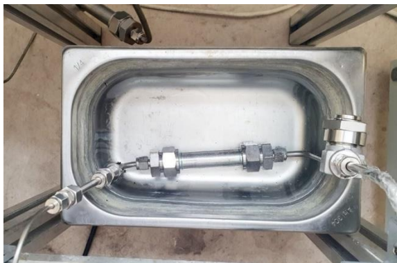
Рисунок 3 – Экстрактор высокого давления объемом 22 мл
