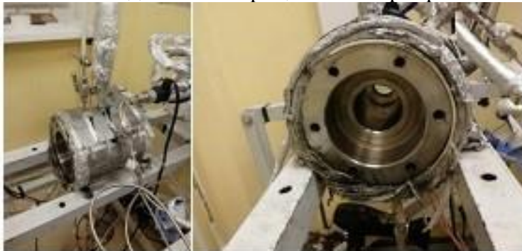
Рисунок 1 – Экстрактор высокого давления объемом 250 мл
