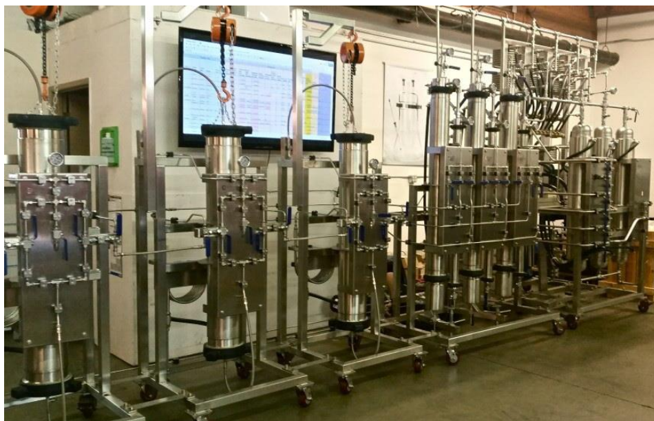
Рисунок 1.4 – Промышленная установка сверхкритической экстракции биологически активных веществ из растительного сырья [53]
