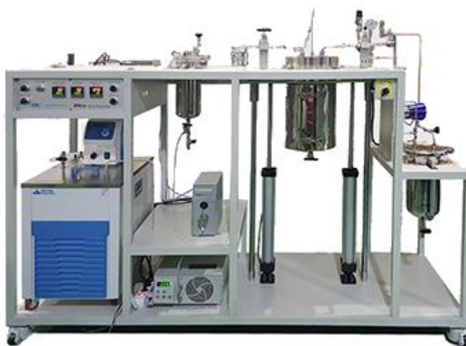
Рисунок 1.6 – Система для сверхкритической флюидной экстракции от компании Rexo Engineering [60]
