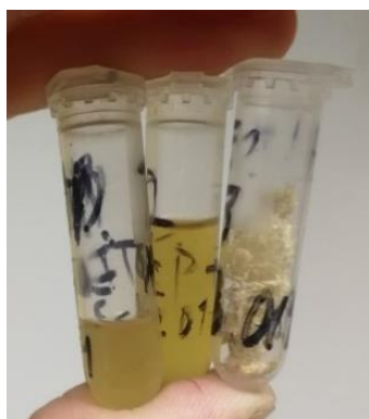
Рисунок 3.24 – Экстракты, полученные методом сверхкритической экстракции при ультразвуковом воздействии (эксперимент 1,2,3 слева направо)
