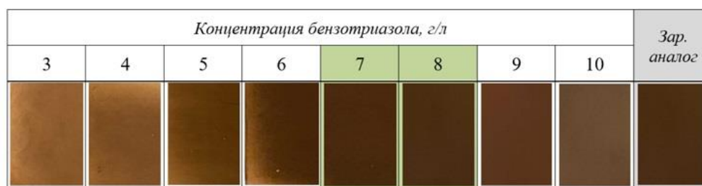
Рисунок 9 – Фотографии поверхности адгезионного слоя, сформированного в растворе микро травления с различной концентрацией бензотриазола
