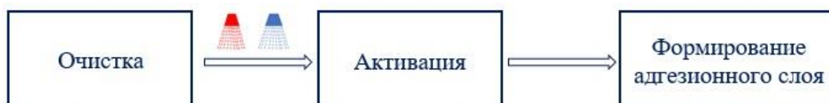
Рисунок 3.1 – Схема технологического процесса подготовки поверхности меди внутренних слоев печатных плат к прессованию [7, 88]
