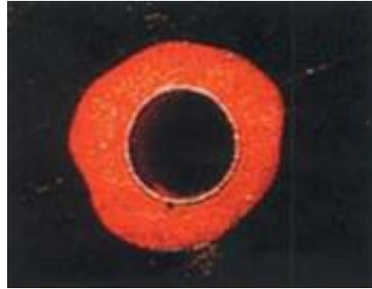
Рисунок 1.12 – Вид дефекта «розового кольца» (горизонтальный разрез) [86]
