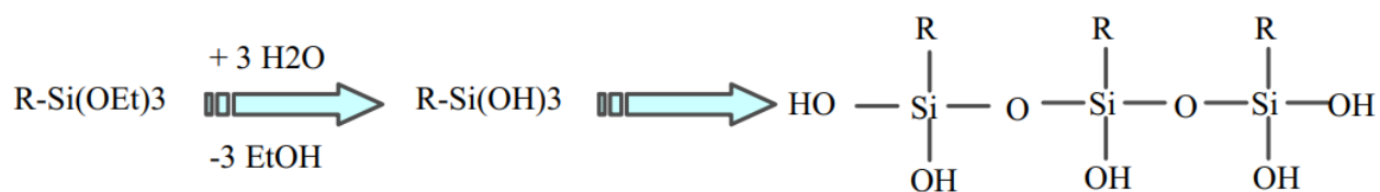
Рисунок 1.24 – Реакции гидролиза и конденсации, протекающие в процессе приготовления раствора органосилана [125]
