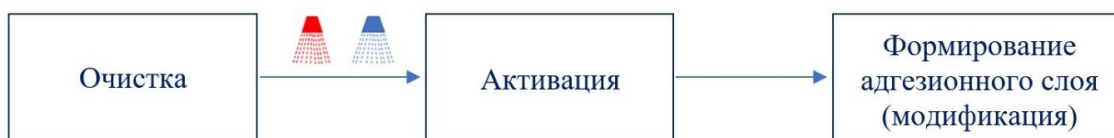
Рисунок 1.13 – Схема технологического процесса формирования металлоорганического адгезионного слоя [7, 88]
