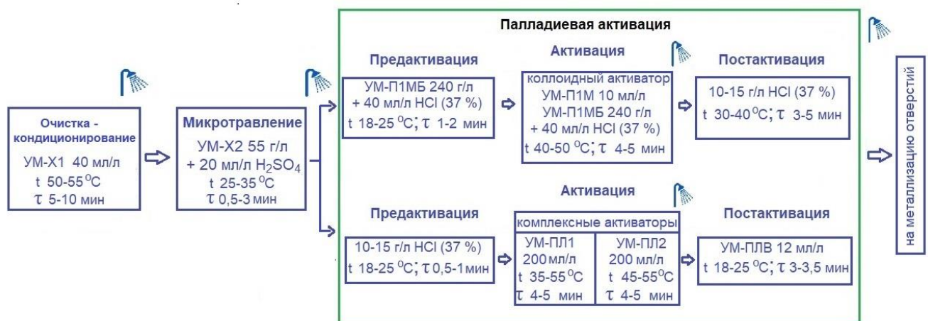
Рисунок 4.1 – Схема технологического процесса подготовки поверхности заготовок печатных плат к химическому меднению
