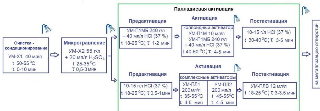
Рисунок 9 – Схема технологического процесса подготовки поверхности печатной платы к химическому меднению
