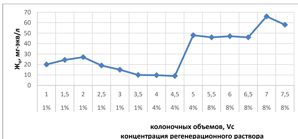
Рисунок 28 - Динамика вытеснения солей жёсткости из пробы катионита раствором серной кислоты нарастающей концентрацией
