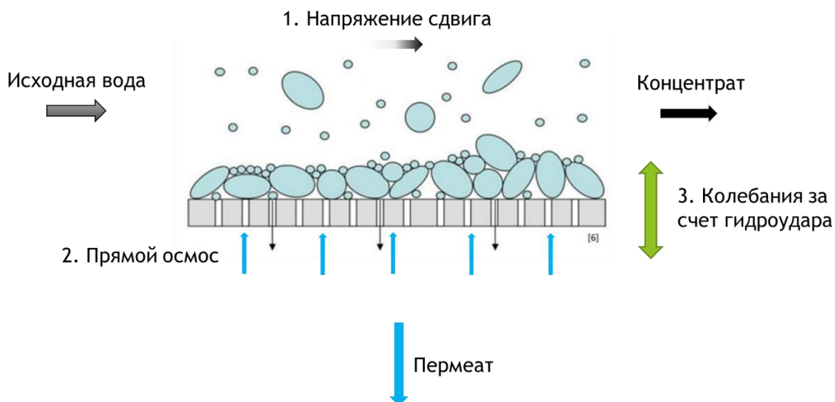
Рисунок 7 - Механизм очистки поверхности мембраны в установке обратного осмоса с пульсирующим потоком
