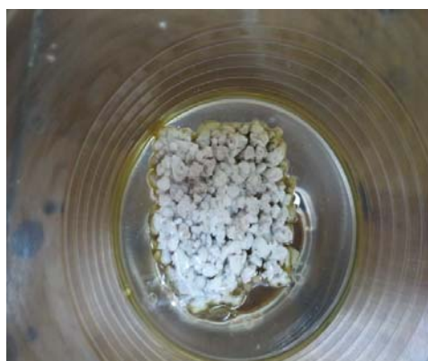
Рисунок 3.6 – Сорбенты с наполнителем перлит с параметрами T_1 и M_1 .
