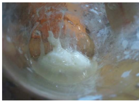
Рисунок 3.10 – Осадок – пенополистирол в вязко-текучем состоянии
