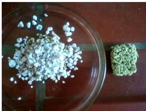
Рисунок 3.1 – Сорбент вермикулит ( M_{в.} = 1, 430\text{г} ) и композитный сорбент с наполнителем вермикулит ( M_{с.в.} = 1, 430\text{г} )*
