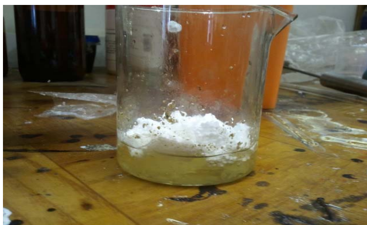
Рисунок 3.9 – Неудачная попытка растворения ПС (дихлорэтан + ПАВ)
