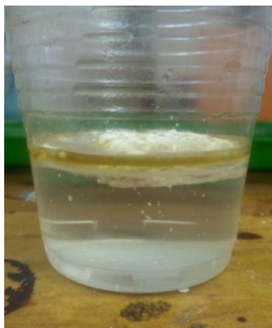
Рисунок 3.17 – Результат работы сорбента с наполнителем перлит
