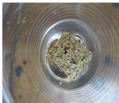
Рисунок 3.7 – Сорбенты с наполнителем вермикулит с параметрами T_1 и M_1 .
