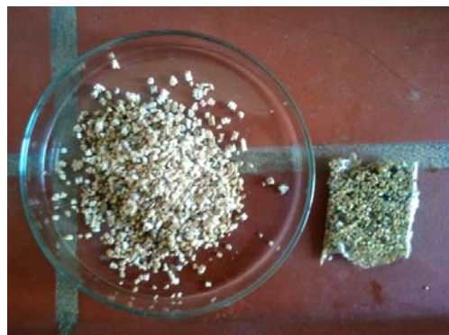
Рисунок 3.2 – Сорбент перлит ( M_{п.} = 1, 341\text{г} ) и композитный сорбент с наполнителем перлит ( M_{с.п.} = 1, 341\text{г} )
