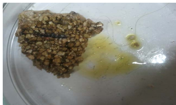
Рисунок 3.16 – Результата работы сорбент с наполнителем вермикулит
