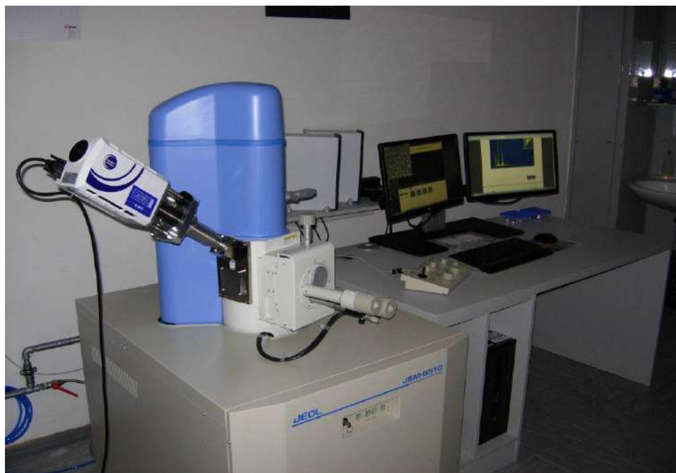
Рисунок 6 – Микроскоп JEOL JSM- 6510LV(Япония)
