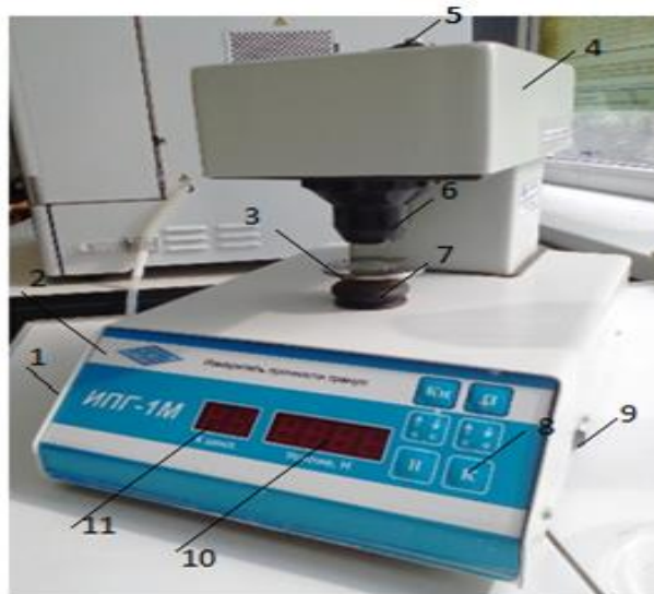
Рисунок 15 – Лабораторный анализатор механической прочности гранул ИПГ-1М: 1 – опорная платформа; 2 – блок электронного управления; 3 – рабочая камера с матрицей; 4 – силовой узел с пуансонным блоком; 5 – механизм фиксации образца; 6 – пуансон; 7 – направляющий шток; 8 – панель ввода параметров; 9 – выключатель питания; 10 – дисплей контроля прилагаемого усилия (Н); 11 – счетчик циклов испытаний
