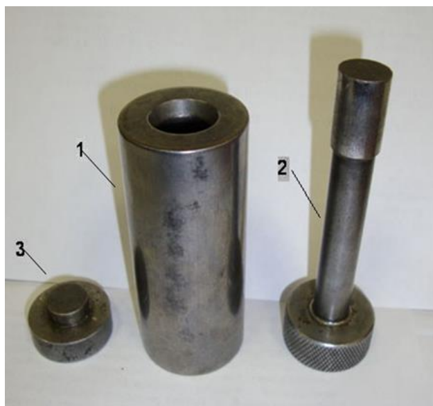
Рисунок 12 – Комплектующие пресс-формы: 1 – матрица; 2 – пуансон; 3 – поддон
