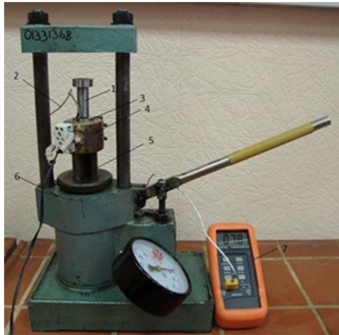
Рисунок 16 – Общий вид экспериментальной установки для исследования процессов проходного прессования и определения бокового давления: 1 – пуансон, 2 – температурный датчик, 3 – матрица проходного прессования, 4 – нагревательный элемент, 5 – полый цилиндр, 6 – гидравлический пресс ПГПР, 7 – термометр контактный
