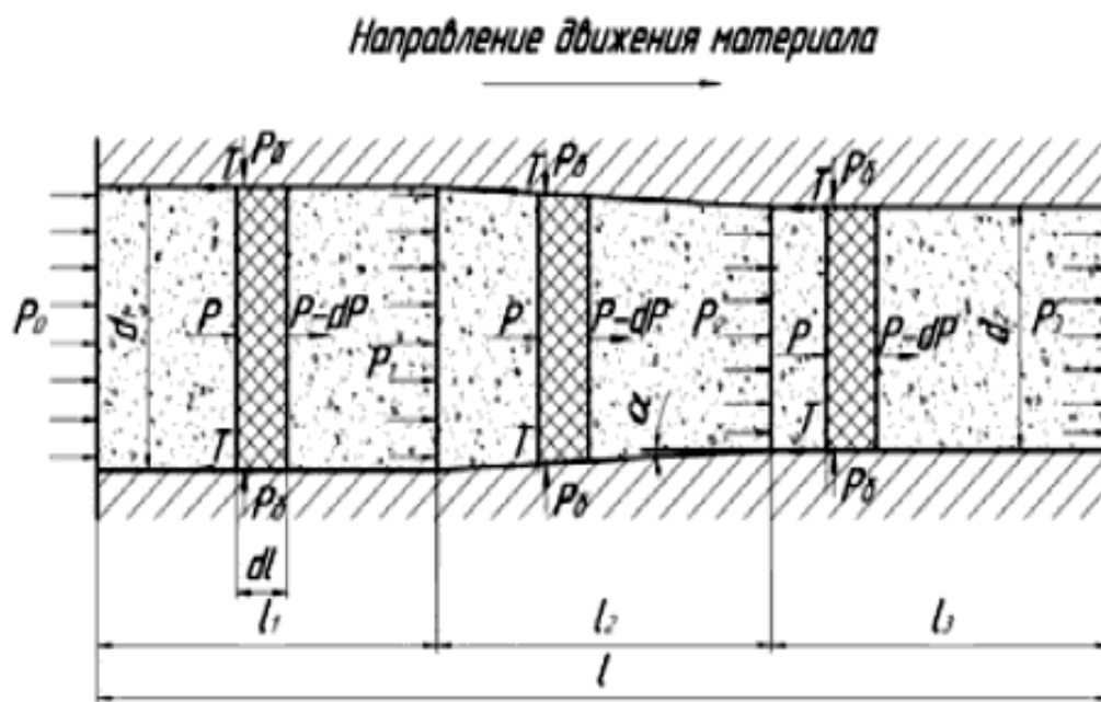
Рисунок 9 – Схема сил, действующих на материал в канале матрицы
