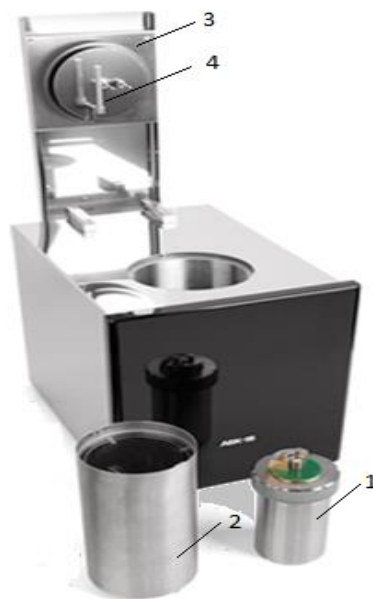
Рисунок 17 – Внешний вид калориметра сгорания бомбового АБК-1В: 1 – калориметрическая бомба; 2 – калориметрический сосуд; 3 – откидная крышка; 4 – контакты цепи зажигания и термометр
