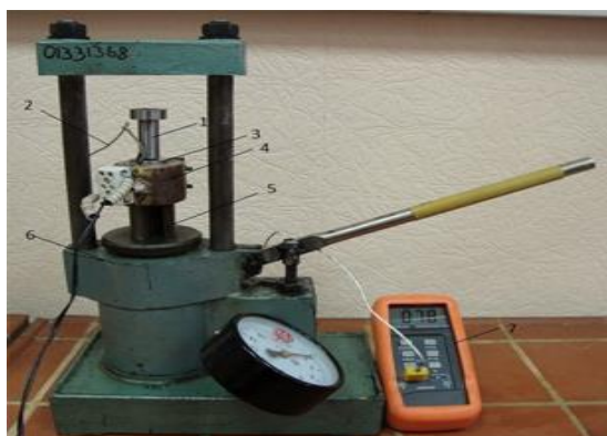
Рисунок 1 – Общий вид экспериментальной установки для исследования процессов проходного прессования и определения бокового давления: 1 – пуансон, 2 – температурный датчик, 3 – матрица проходного прессования, 4 – нагревательный элемент, 5 – полый цилиндр, 6 – гидравлический пресс ПГПР, 7 – термометр контактный
