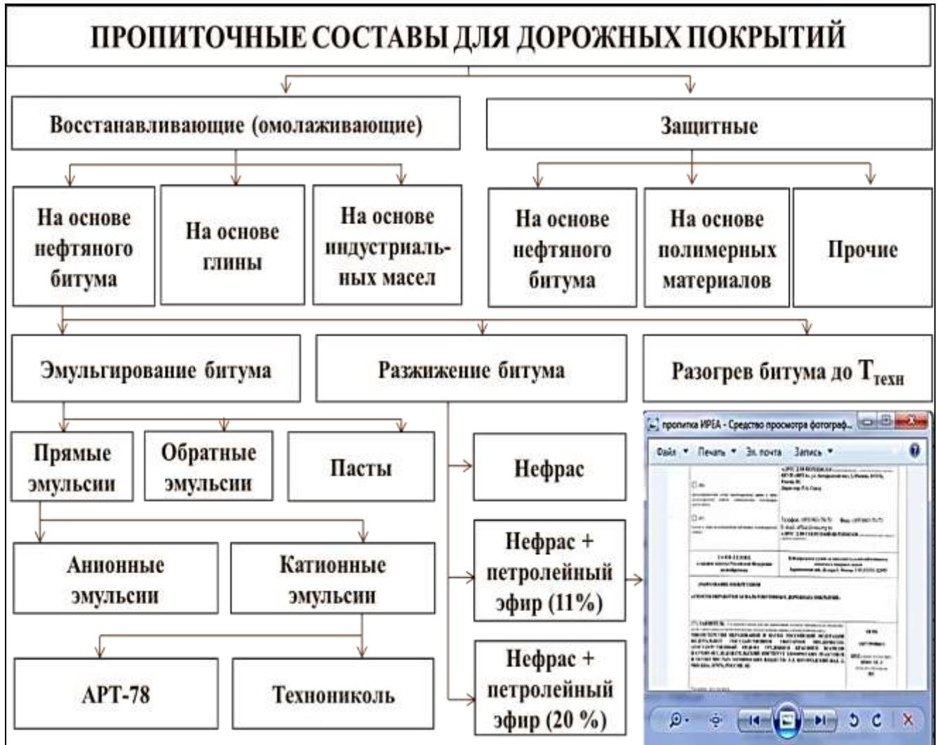
Рисунок 5.1 – Структура КМК-системы дорожных пропиток.
