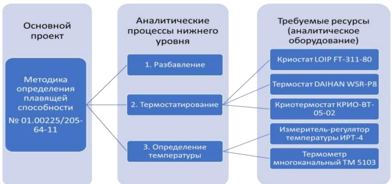
Рисунок 2.15– модернизированная иерархическая структура проекта в КМК-системе «определение плавящей способности ПГР»
