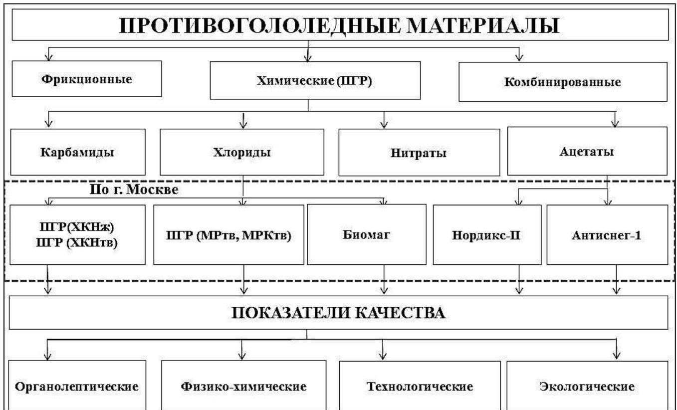
Рисунок 2.4 – Структура верхних уровней КМК-системы противогололедных материалов (анализируемые ПГМ-ПГР – показатели качества)
