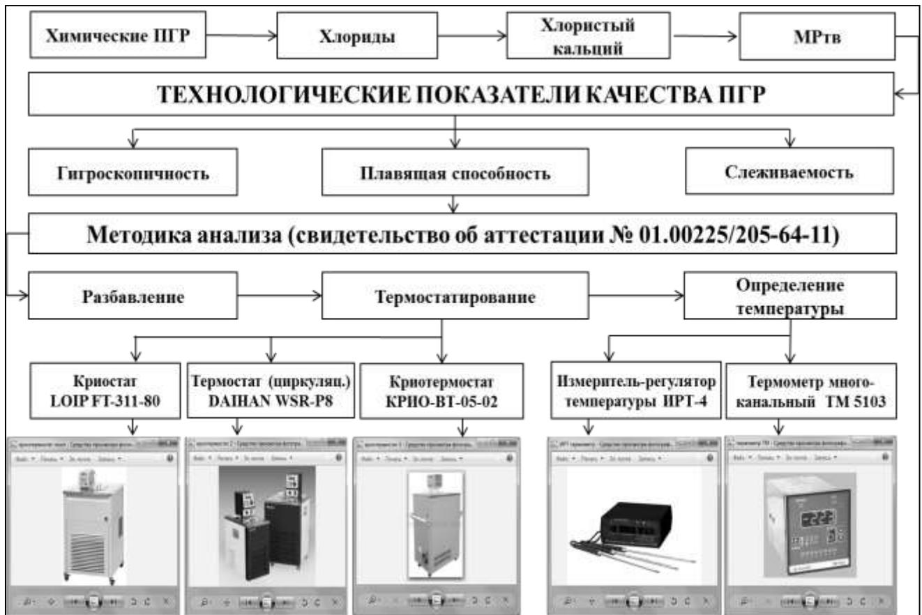
Рисунок 2.14 – Разработка аналитической методики определения плавающей способности противогололедных реагентов
