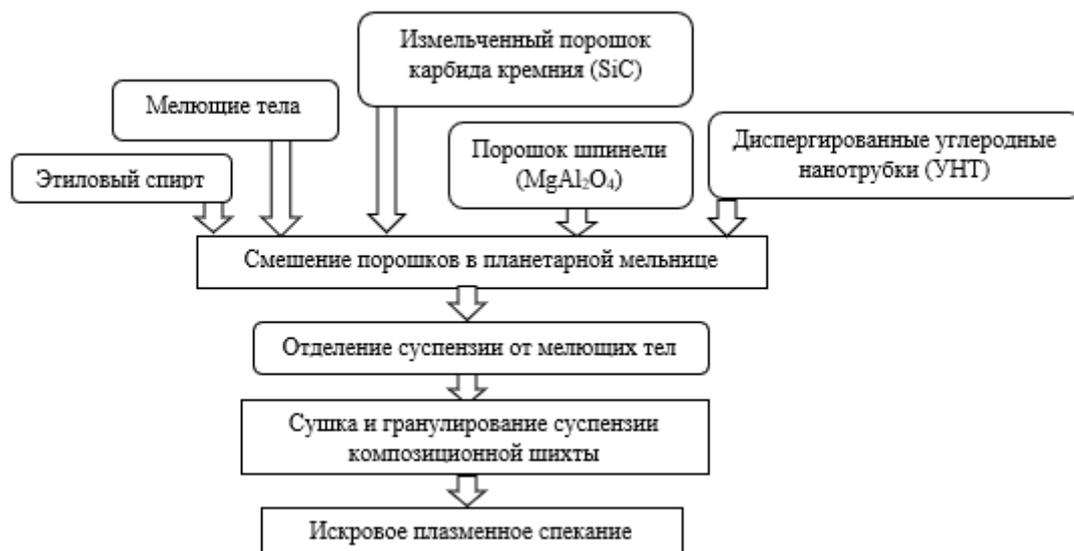
Рисунок 2.31 – Схема получения образцов композита SiC-MgAl<sub>2</sub>O<sub>4</sub>-УНТ методом искрового плазменного спекания
