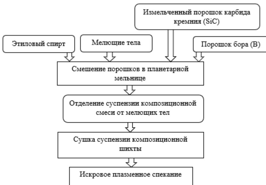
Рисунок 2.37 - Схема процесса получения образцов композита состава SiC – B
