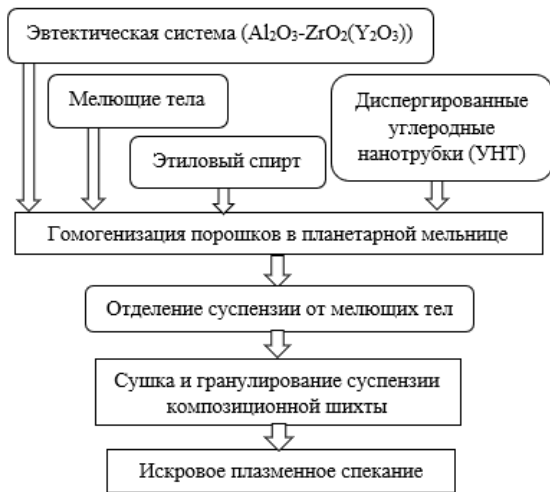
Рисунок 1 – Схема процесса получения образцов композита Al_2O_3 - ZrO_2(Y_2O_3) -1% УНТ
