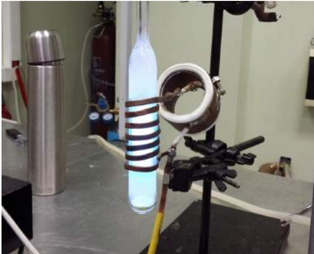
Рисунок 5.2 – Установка по определению суммарного углерода в объемных образцах серы
