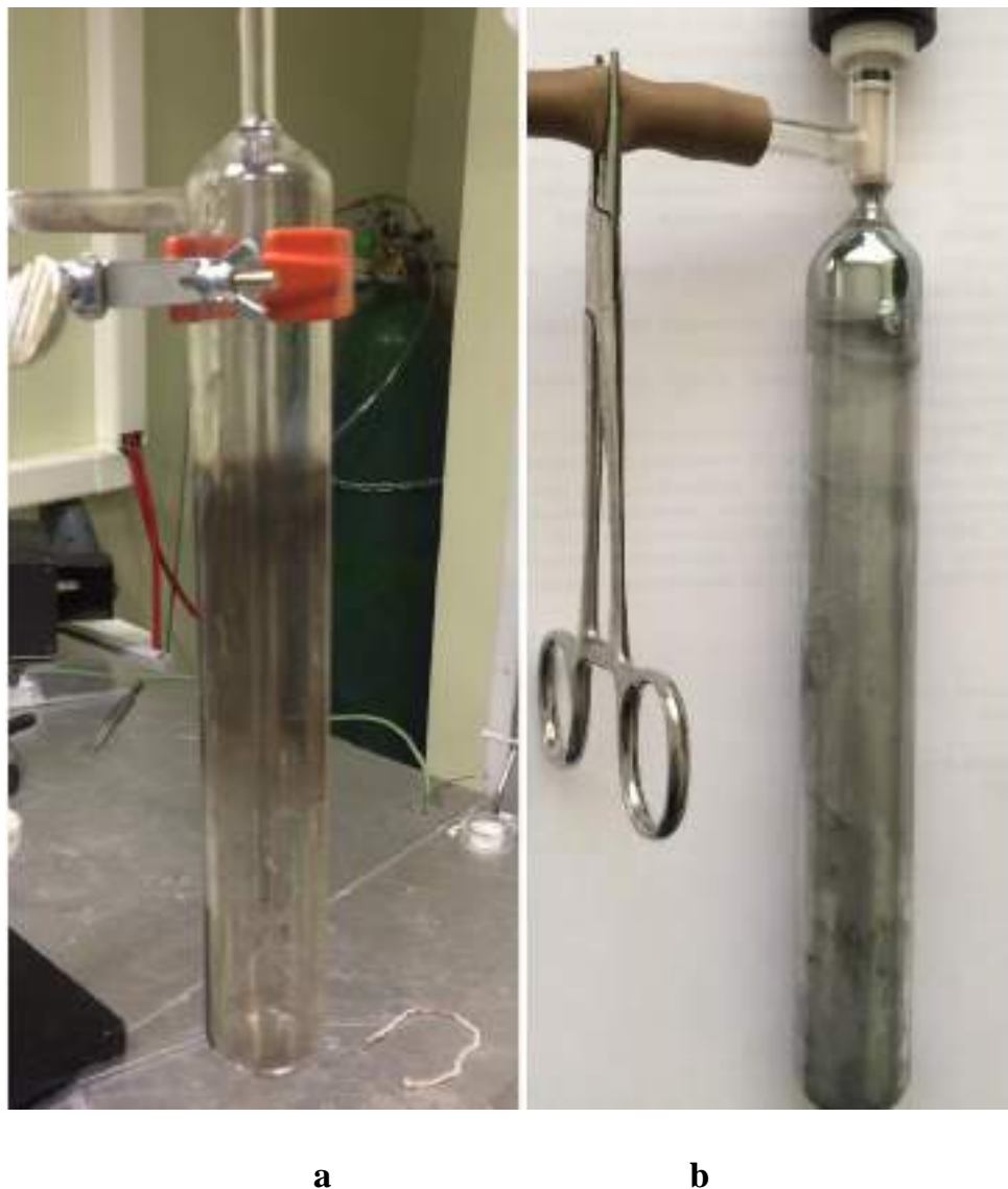
Рисунок 5.45 – Начало процесса разложения гидрида теллура ( a ), конечное состояние ампулы с осажденным теллуром на стенках ( б )
