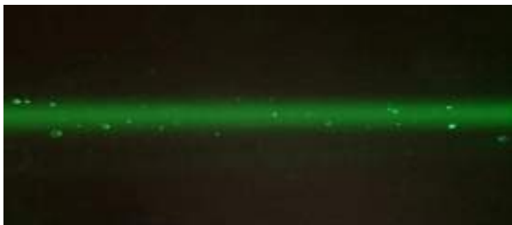
Рисунок 5.4 – Уровень загрязнения кюветы до специальной очистки
