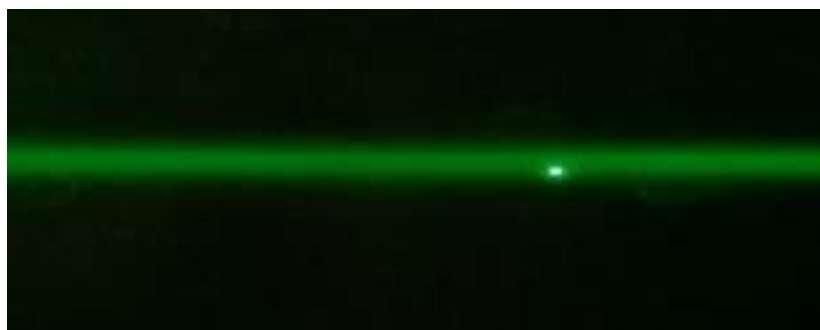
Рисунок 5.5. Уровень загрязнения кюветы после специальной очистки
