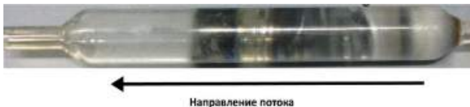
Рисунок 3.21 – Плазмохимический реактор с головной фракцией галлия после плазмохимического процесса
