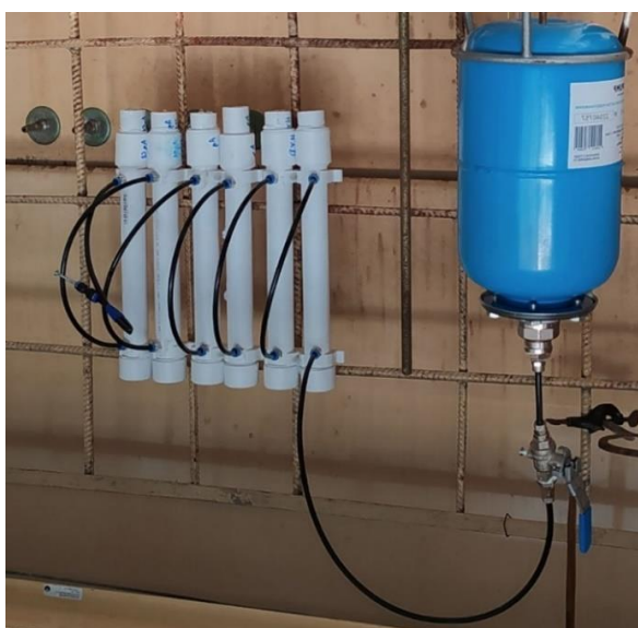
Рисунок 4.3 – Насыщение образцов компактированного бентонита модельной водой НКМ перед началом экспериментов по диффузии
