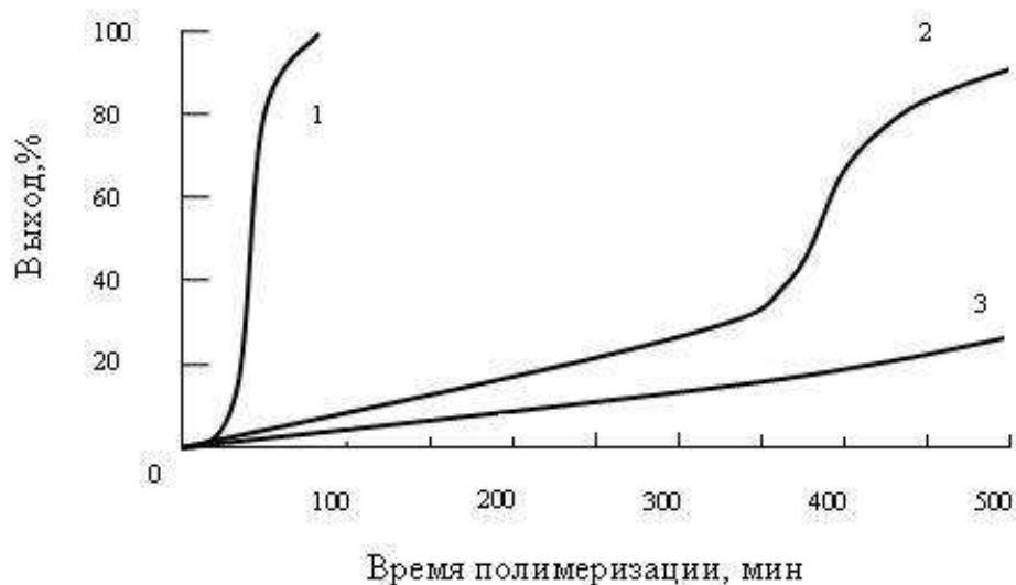
Рисунок 16 – Зависимость выхода полимеров от времени полимеризации (60°C, 0,1% пероксида бензоила): 1- акрилонитрил; 2-метилметакрилат; 3-бутилметакрилат
