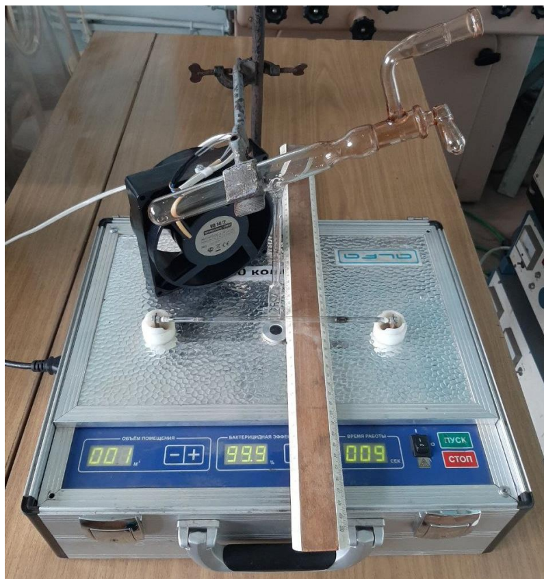
Рисунок 2 – Установка с УФ-лампой, на которой находится вентилятор для охлаждения, а также ячейка с кюветой, содержащей раствор.
