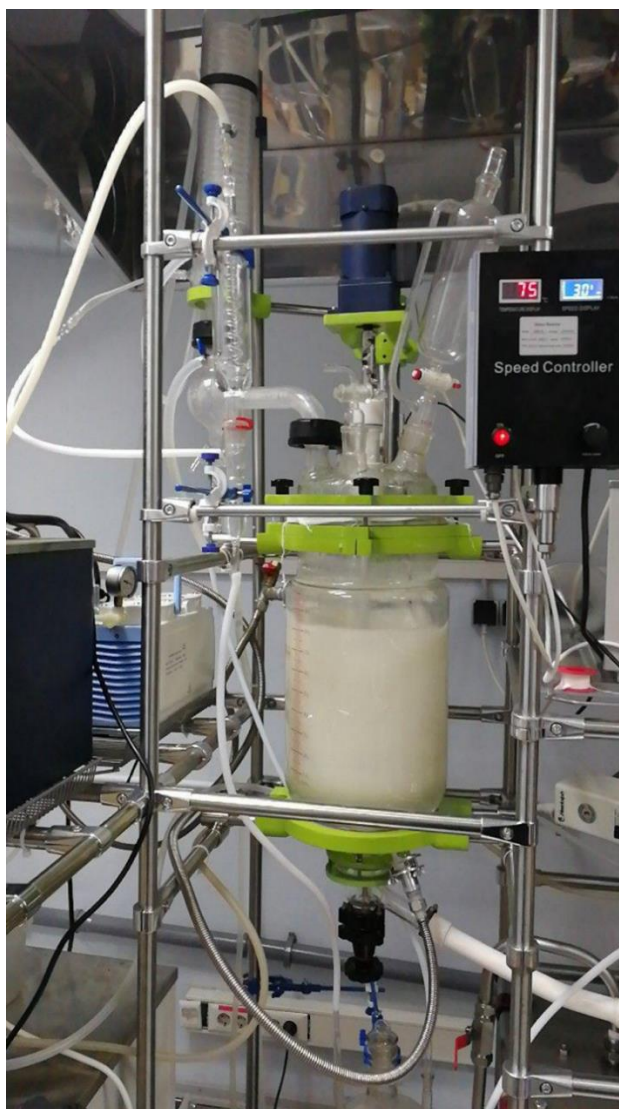
Рисунок 3.29 – Фотография 10 л реактора в процессе синтеза.
