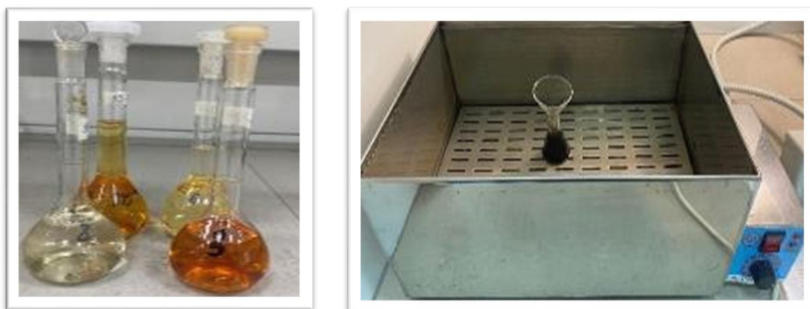
Рисунок 3.5 – Пробоподготовка ОИАИ для анализа на атомно–абсорбционном спектрофотометре
