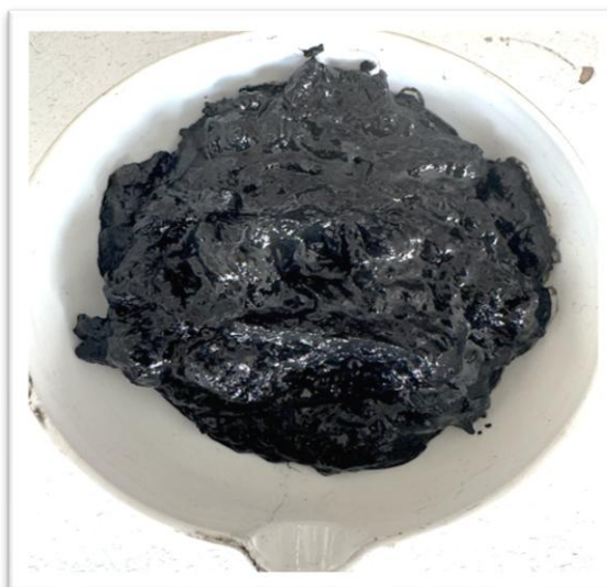
Рисунок 3.2 – Внешний вид исходного сырья: механически обезвоженный избыточный активный ил
