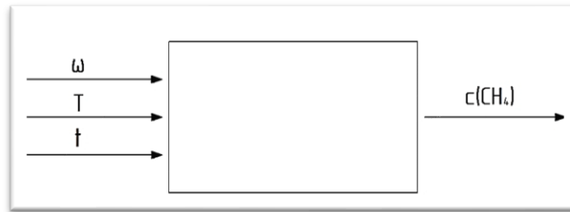
Рисунок 3.27 – Влияние основных действующих факторов процесса пиролиза на выход газа
