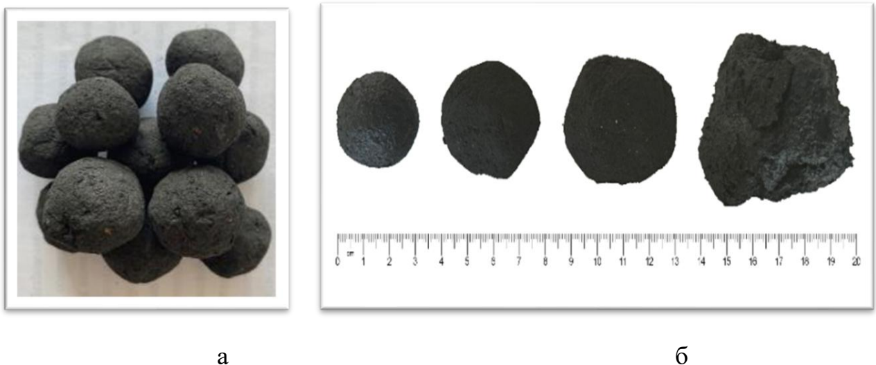
Рисунок 3.7 – Получаемые топливные гранулы: а – внешний вид, б – варьирование размера гранул в процессе формования смеси
