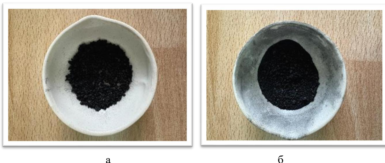
Рисунок 3.23 – Углеродный остаток после пиролиза различного исходного сырья: а – ОИАИ; б – некондиционные угольные материалы (угольная пыль)
