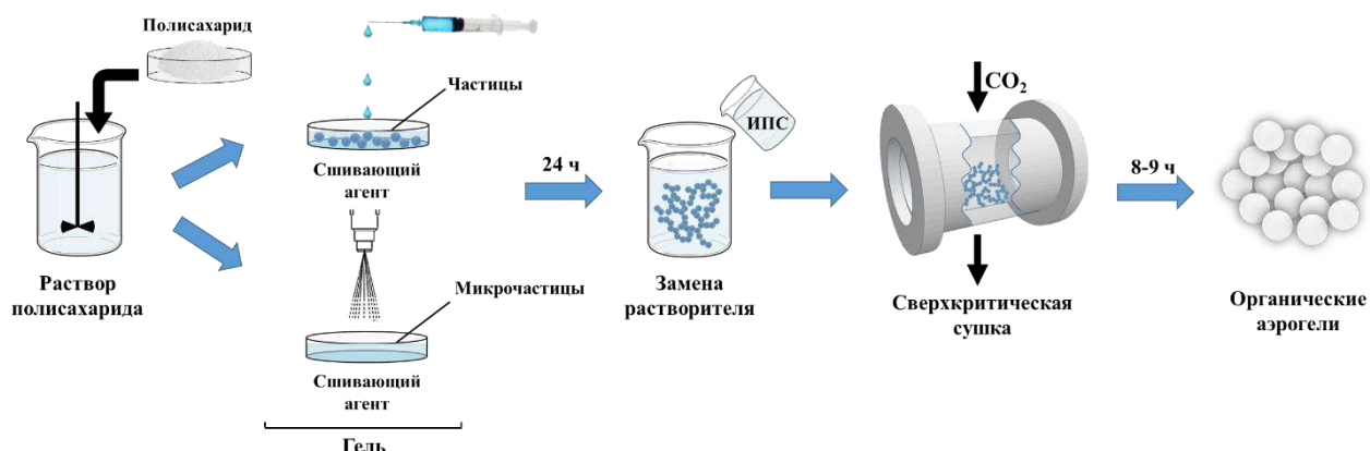
Рисунок 2.3 – Общая схема процессов получения органических аэрогелей на основе полисахаридов
