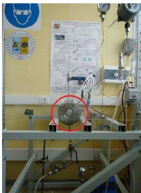
Рисунок 2.11 – Внешний вид и принципиальная схема установки объемом 250 мл для проведения сверхкритических процессов: 1 – баллон с жидким CO 2 , 2 – конденсатор, 3 – поршневой насос, 4 – нагревательный элемент, 5 – аппарат высокого давления, 6 – система терморегулирования, 7 – сепаратор с охлаждающей рубашкой, 8 – ротаметр, 9 – емкость с растворителем, 10 – мембранный насос, PI – манометр, TC – датчик температуры, TI – датчик температуры
