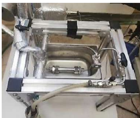
Рисунок 2.9 – Внешний вид и принципиальная схема установки объемом 250 мл для проведения сверхкритических процессов: 1 – баллон с жидким \text{CO}_2 , 2 – конденсатор, 3 – поршневой насос, 4 – терморегулятор, 5 – аппарат высокого давления, 6 – нагревательная баня, 7 – сепаратор с охлаждающей рубашкой, FT – датчик расхода газа, PT – датчик давления, TE – датчик температуры
