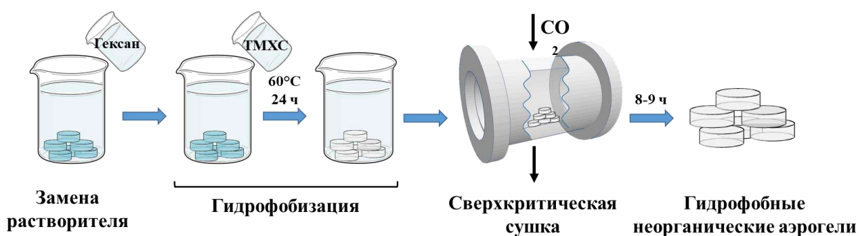
Рисунок 2.2 – Общая схема процессов получения гидрофобных неорганических аэрогелей на основе диоксида кремния
