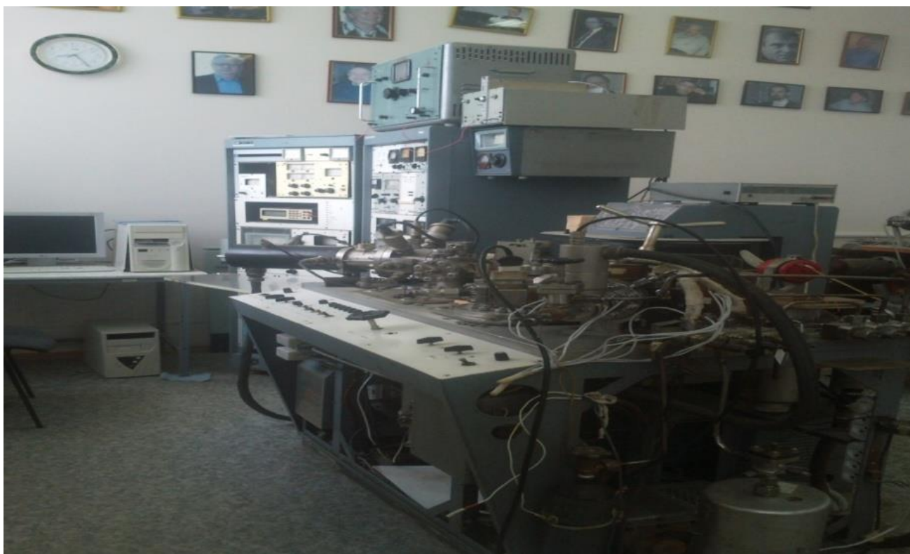
Рисунок 2 – Переоборудованный для работы в режиме генерации/регистрации отрицательных ионов магнитно-секторный масс-спектрометр МИ-1201В, используемый в ИФМК
