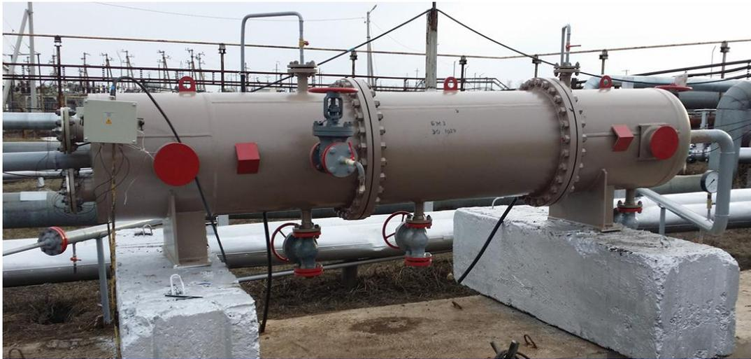
Рисунок 4.2. Пилотная установка волнового воздействия
