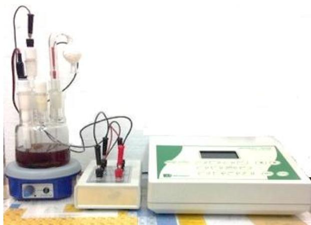
Рисунок 2.3. Общий вид титратора Фишера «ЭКСПЕРТ – 007М» с бипотенциометрической индикацией
