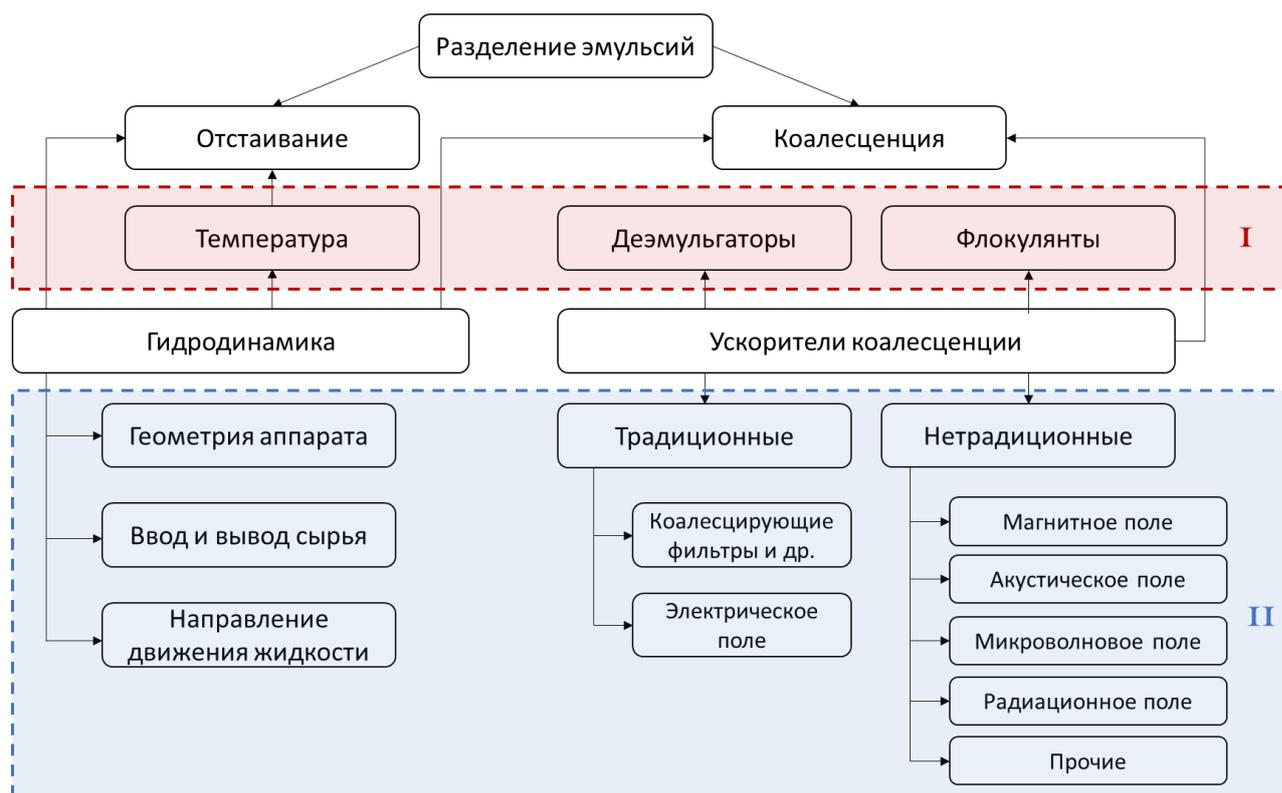
Рисунок 1.9. Основные управляющие факторы, определяющие процесс разделения водонефтяных эмульсий: I – технологические управляющие параметры; II – конструктивные управляющие параметры [116]
