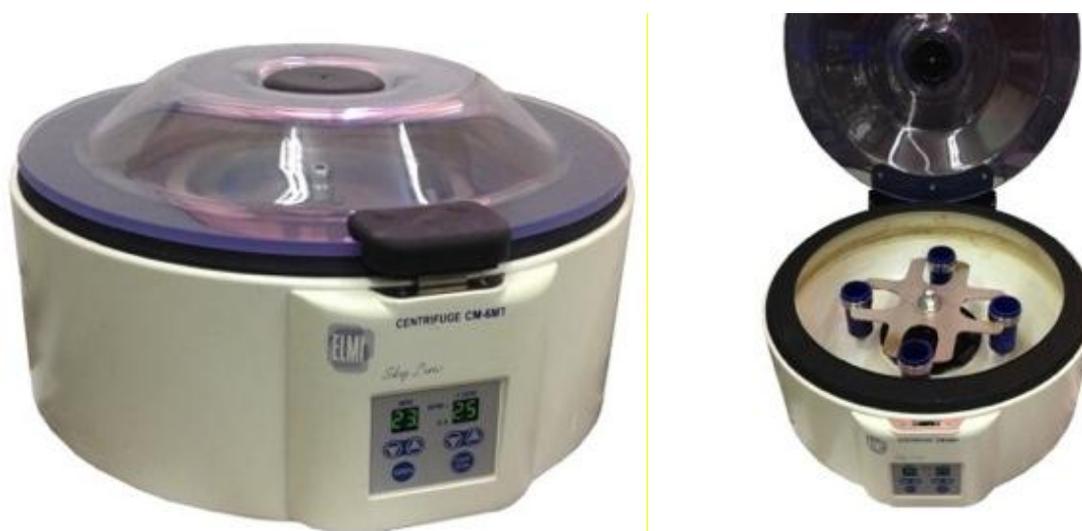
Рисунок 2.1. Общий вид центрифуги CM-6MT
