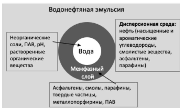
Рисунок 1.2. Схема компонентного состава дисперсионной среды, дисперсной фазы и межфазного слоя водонефтяной эмульсии [39]
