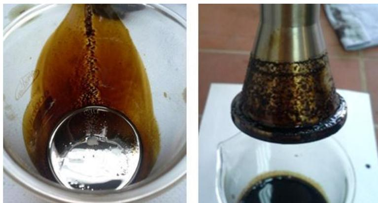
Рисунок 3.30. Образец эмульсий №1-1 после ультразвуковой обработки в течение 1 мин
