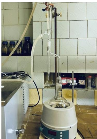
Рисунок 2.2. Общий вид аппарата Дина-Старка
