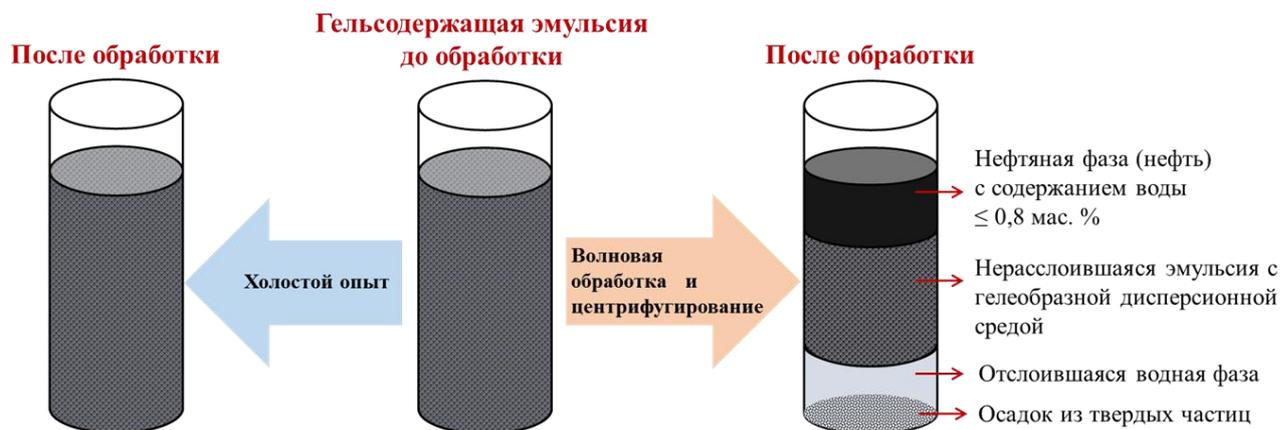
Рисунок 3.25. Расслаивание на фазы гелеобразной эмульсии после волновой обработки и центрифугирования
