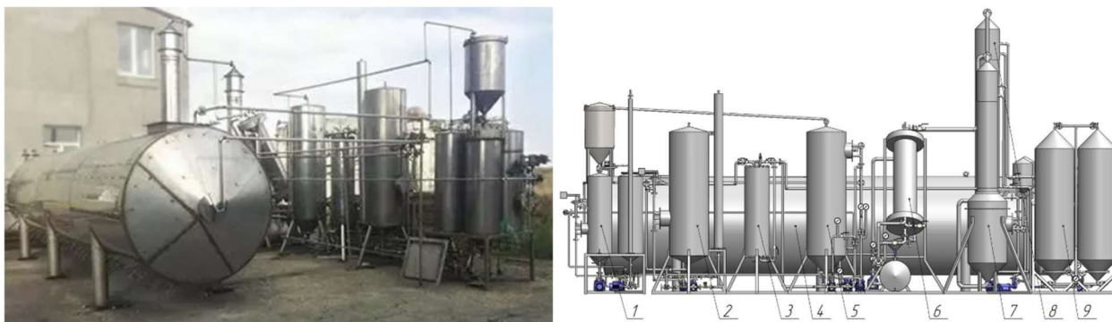
Рисунок 7 – Фото и планировка коммерческой установки производства биодизеля [129]
