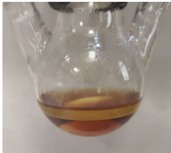
Рисунок 21 – Схема и фото реакционной смеси алкоголиза МЭЖК этиленгликолем
