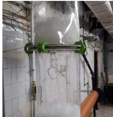
Рисунок 2 – Пенный слой в работающей установке
