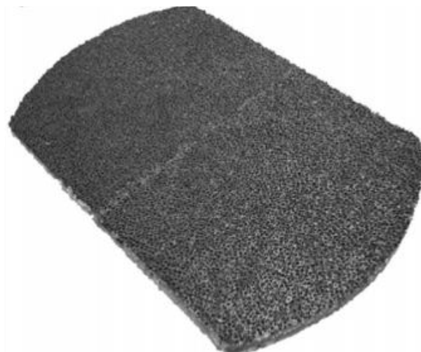
Рисунок 1.5 – Тарелка из вспененной керамики (SiC)
