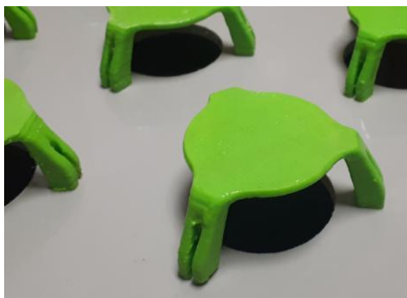
Рисунок 2.4 – Фиксированные клапаны, экспериментальная тарелка
