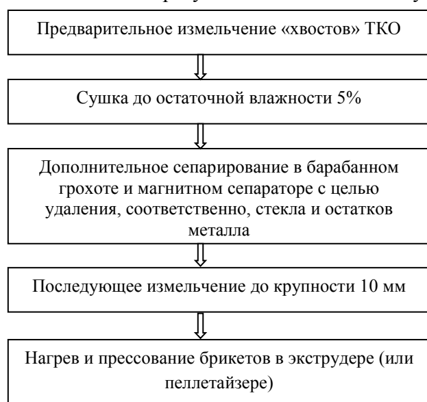
Рисунок 1 – Схема производства RDF из остаточной части ТКО после сортировки на мусоросортировочной станции.
