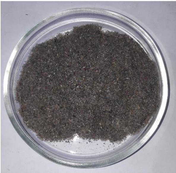
Рисунок 2.7 - Измельченный образец RDF до крупности менее 1 мм
