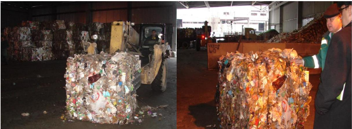
Рисунок 2.2 - Брикеты («хвосты») после сортировки на мусоросортировочной станции г. Липецка
