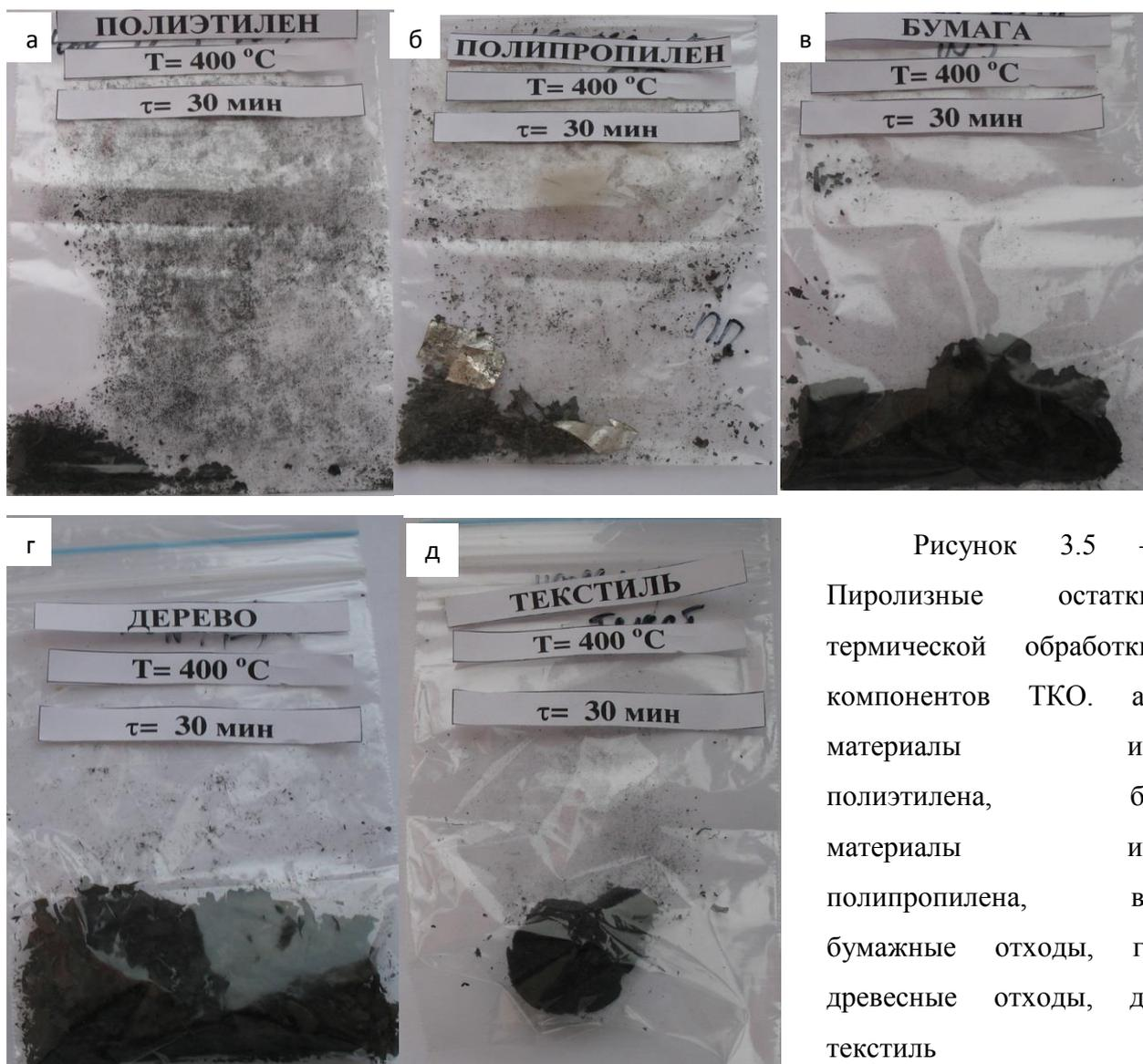
Рисунок 3.5 – Пиролизные остатки термической обработки компонентов ТКО. а) материалы из полиэтилена, б) материалы из полипропилена, в) бумажные отходы, г) древесные отходы, д) текстиль
