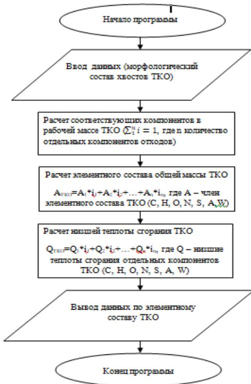
Рисунок 4.6 - Блок-схема программы расчета свойств RDF на основе морфологического состава «хвостов» ТКО
