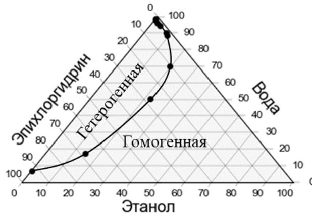
Рисунок 2.7 – Фазовая диаграмма трехкомпонентной системы «эпихлоргидрин – этанол – вода» при температуре 298 К и атмосферном давлении
