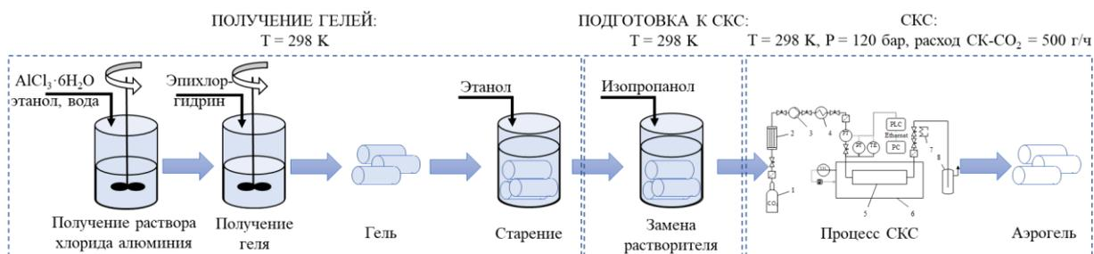
Рисунок 2.1 – Схематическое представление процесса получения монолитов аэрогелей на основе оксида алюминия
