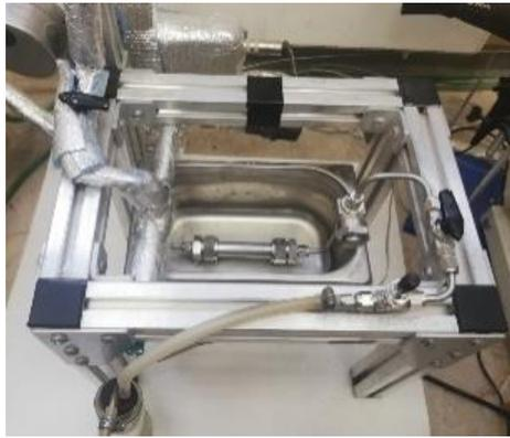
Рисунок 3.2 – Внешний вид установки для проведения сверхкритической сушки при ультразвуковом воздействии
