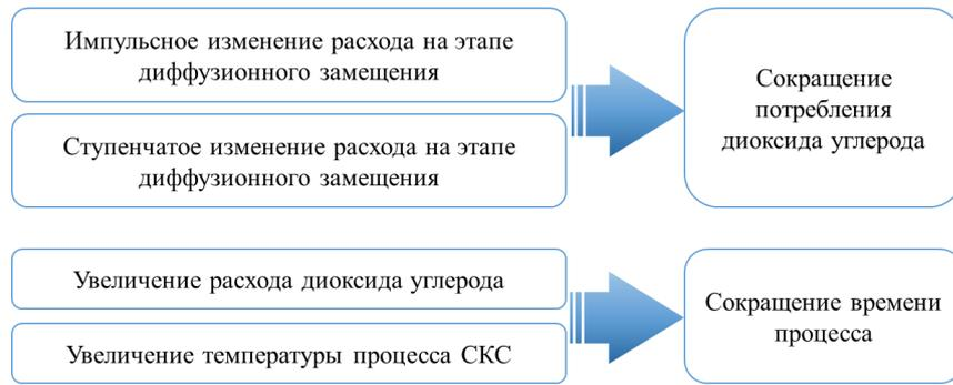
Рисунок 3.15 – Оптимизация режимно-технологических параметров процесса сушки
