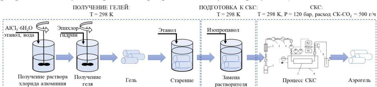
Рисунок 2 – Схематическое представление процесса получения монолитов аэрогелей на основе оксида алюминия
