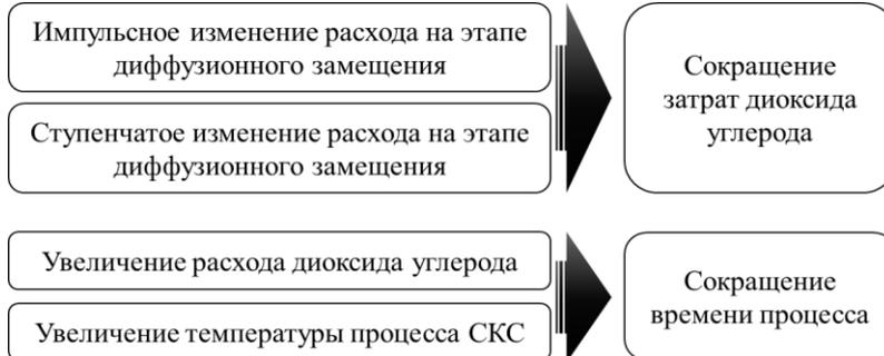
Рисунок 13 – Оптимизация режимно-технологических параметров процесса сверхкритической сушки при давлении 120 бар. В таблицах 3 и 4 представлены результаты исследований по сокращению потребления диоксида углерода и времени процесса сушки.
