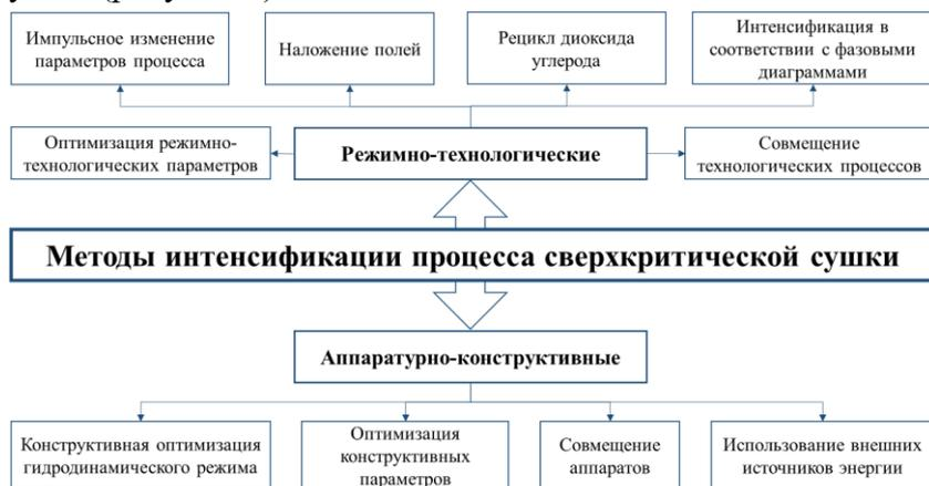
Рисунок 7 – Методы интенсификации процесса сверхкритической сушки
