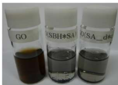
Рисунок 1.21 – Восстановление ОГ (образец GO), в \text{NaBH}_4 и затем в \text{H}_2\text{SO}_4 (образец SBH*SA) и в разбавленной, а затем концентрированной \text{H}_2\text{SO}_4 (образец SA_d*c) [128]
